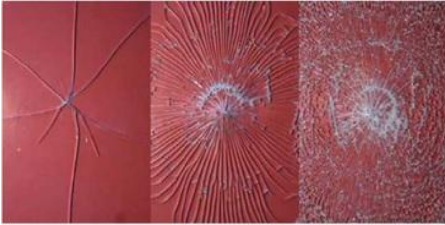
Εικόνα 21. Μορφή θραύσης γυαλιού. Από αριστερά ανοπτημένο , heat strengthened, toughened [5]
