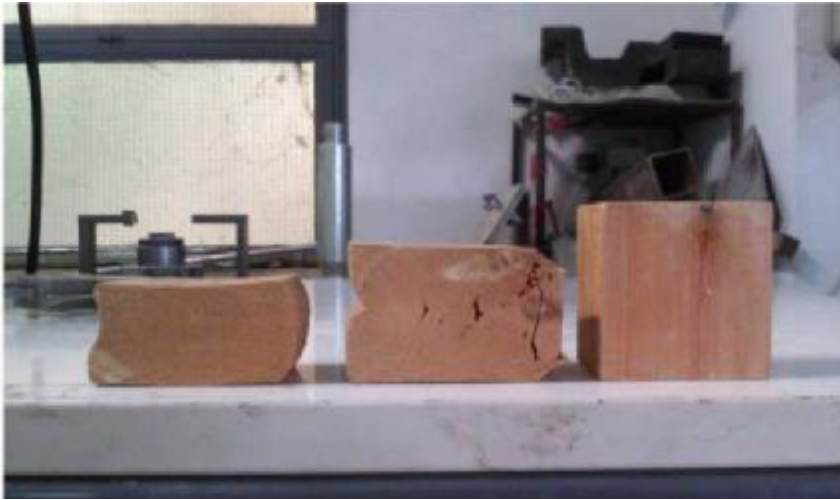
Εικόνα 16. Δοκίμια ξύλου από θλιπτική καταπόνηση. Από αριστερά α) ακτινική, β) εφαπτομενική, γ) αξονική [4]
