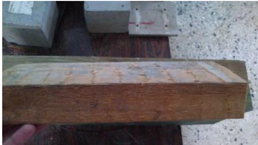
Εικόνα 18. Αστοχία δοκιμίου D40 σε κάμψη τεσσάρων σημείων. [4]
