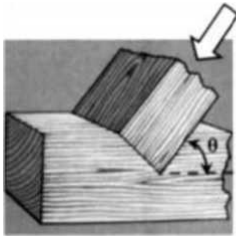
Εικόνα 17. Γωνία \theta μεταξύ διεύθυνσης φόρτισης και ινών. [4]
