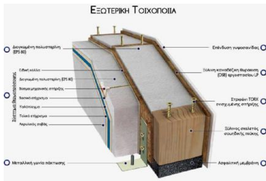
Εικόνα 23. Τρισδιάστατη τομή εξωτερικής τοιχοποιίας Κοφινάς [4]
