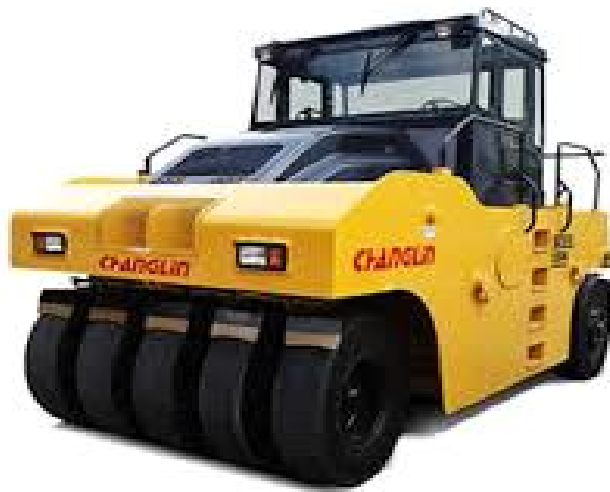
Εικόνα13: οδοστρωτήρας με ελαστικούς τροχούς
