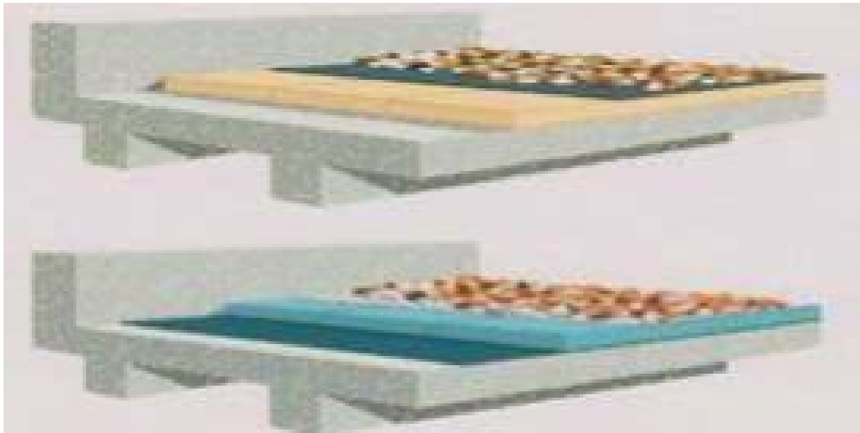
Εικόνα 5: Σύγκριση ανεστραμμένης και συμβατικής μόνωσης
