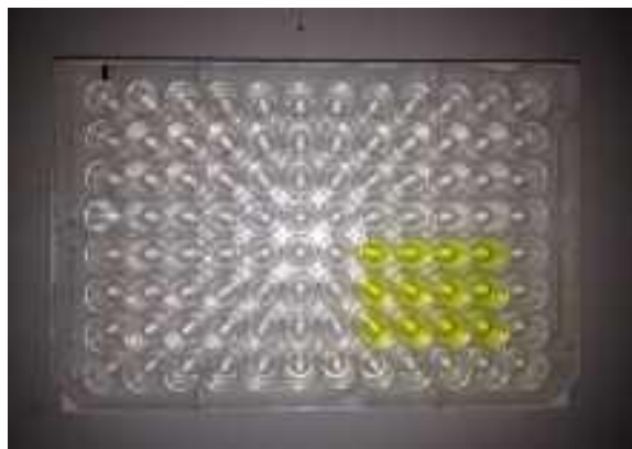
Μικροπλάκα πολυστυρενίου των 96 βοθρίων. Αλλαγή χρωματισμού όπου έχει τοποθετηθεί θετικό δείγμα
