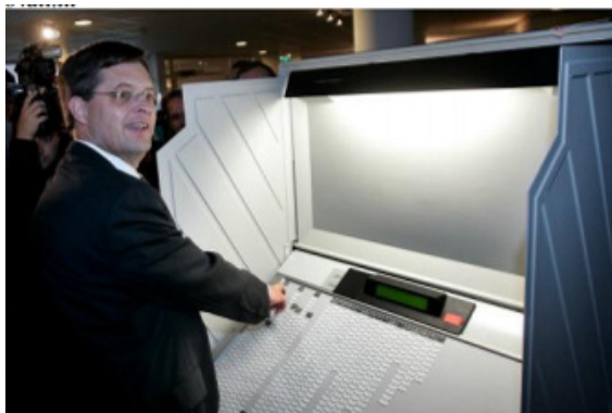
Εικόνα 15: Η συσκευή DRE που χρησιμοποιούνταν στις εκλογές στην Ολλανδία μέχρι το 2008 (Loeber, 2014)
