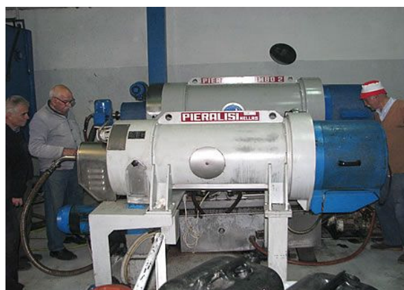
Εικόνα 20: Φυγοκέντρωση της ελαιοζύμης
