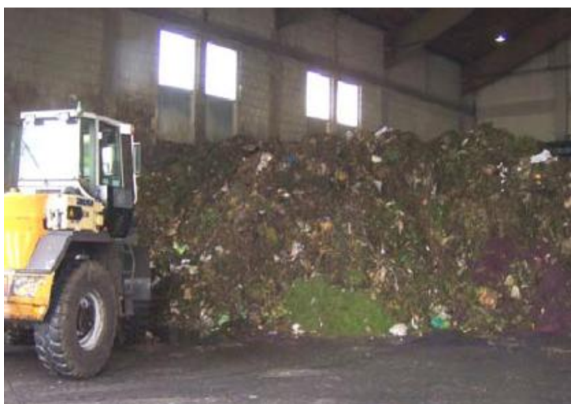
Εικόνα 3.3 Δημοτικά στερεά απόβλητα παρεχόμενα σε εγκατάσταση βιοαερίου στη Γερμανία [21]
