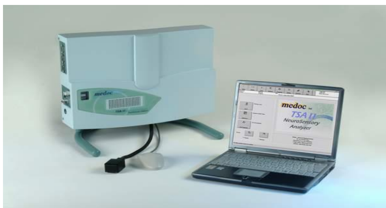
Εικ.11 Thermal Sensory Analyzer (TSA, 2001), είναι μια συσκευή ακριβείας ελεγχόμενη από Η/Υ ικανή να παράγει, ποσοτικοποιεί και να αρχειοθετεί μια απάντηση σε υψηλό ερέθισμα όπως ο πόνος, η δόνηση, το κρύο και η ζέστη
