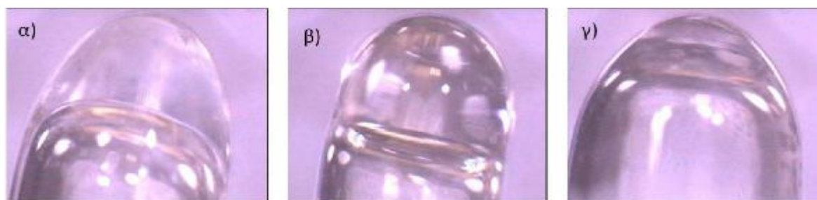
Εικόνα 3.5: Φωτογραφίες των τριών τύπων καλυπτρίδων χαλαζία, από οπτικό μικροσκόπιο. α) Τρούλος (dome), β) σφαιρική (ball) γεωμετρία και γ) επιπεδό-κυρτη γεωμετρία [9].
