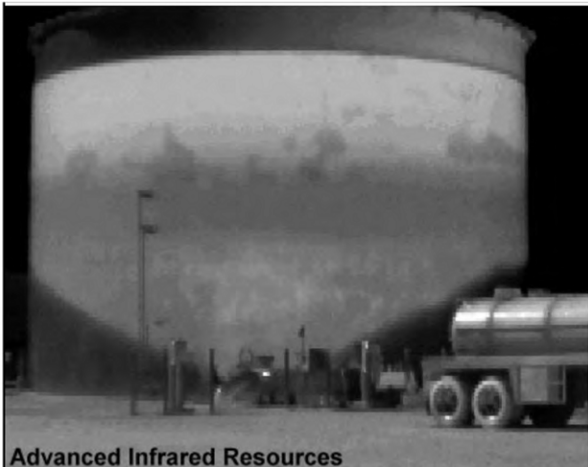
Σχήμα 8.5 Παρατηρήστε τη στάθμη υγρού και την καθίζηση της δεξαμενής (εικόνα με την άδεια: www.infraredthermography.com )
