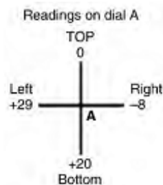
Σχήμα 6.27 Οι ενδείξεις δείχνουν κρέμασμα στον μετρητή A[1]
