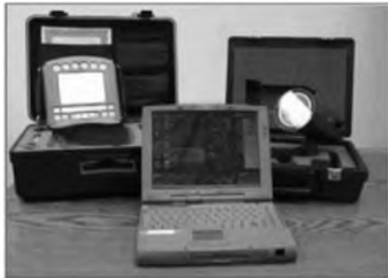
Σχήμα 3.10 Συλλέκτες δεδομένων / αναλυτές με πακέτο αξεσουάρ που διατίθενται στο εμπόριο[1]
