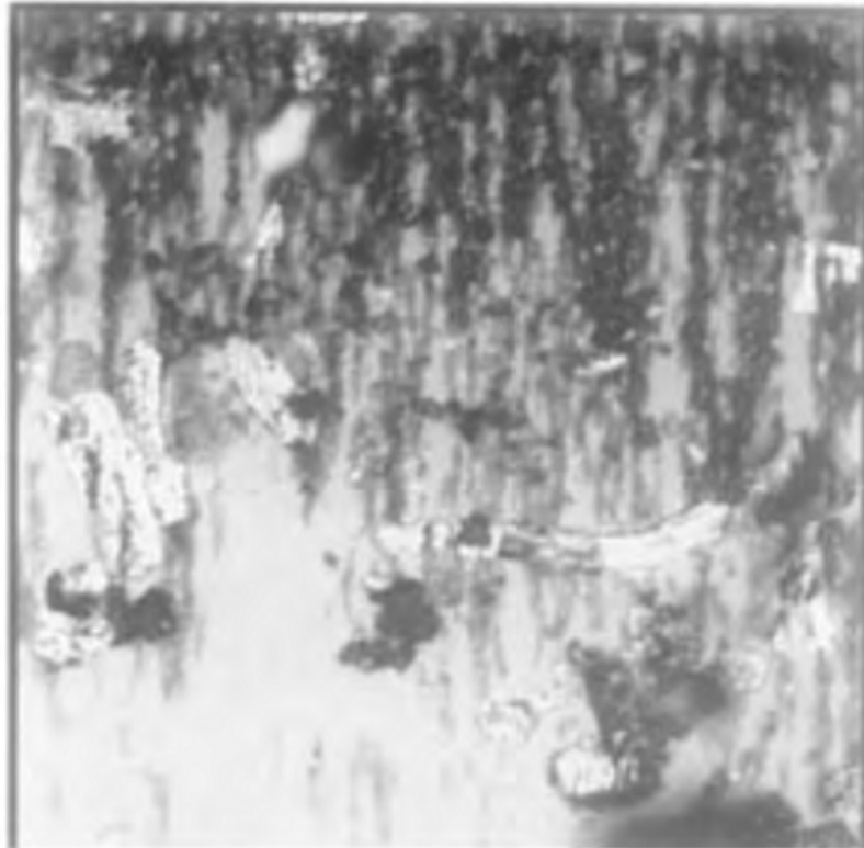
Σχήμα 7.22 Φθορά κράματος χαλκού[1]
