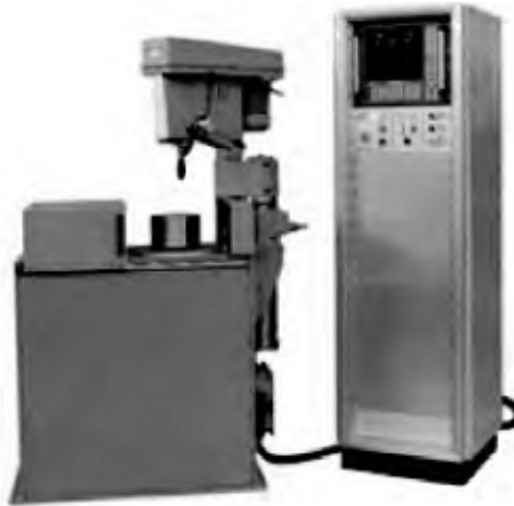
Σχήμα 6.6 Μηχάνημα κάθετης εξισορρόπησης με προσθήκης κεφαλής τρυπανιού (μηχανές εξισορρόπησης Schmitt) [1]
