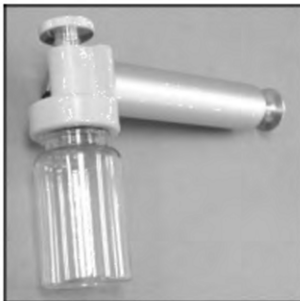
Σχήμα 7.2 Φιαλίδιο δειγματοληψίας με αντλία κενού[1]
