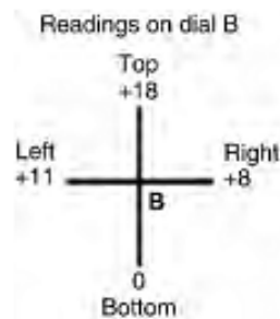
Σχήμα 6.28 Οι ενδείξεις δείχνουν κρέμασμα στον μετρητή B[1]
