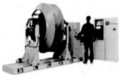
Σχήμα 6.5 Μηχάνημα εξισορρόπησης σκληρών εδράνων (μηχάνημα εξισορρόπησης IRD) [1]
