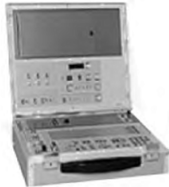
Σχήμα 3.22 Μετρητές στρεπτικής ταλάντωσης (πηγή: Ονο Sokki, Ιαπωνία Τεχνική Έκθεση, ιστοσελίδα)
