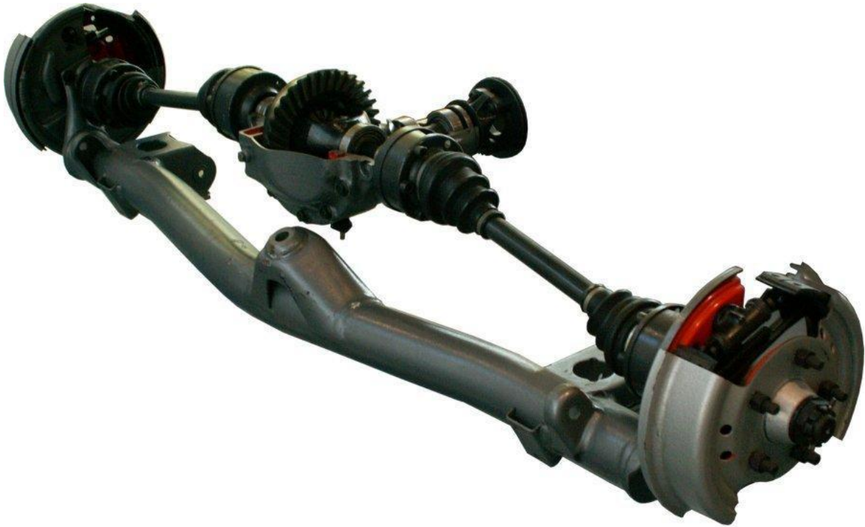
Σχήμα 2.3: Σύστημα ανάρτησης με άξονα De Dion ( www.kfz-tech.de )
