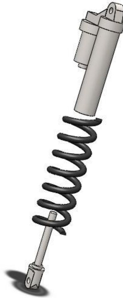
Σχήμα 5.51: Ζεύγος ελατηρίου-αποσβεστήρα. Από πάνω προς τα κάτω: Άνω τμήμα αποσβεστήρα, ελατήριο, κάτω τμήμα αποσβεστήρα
