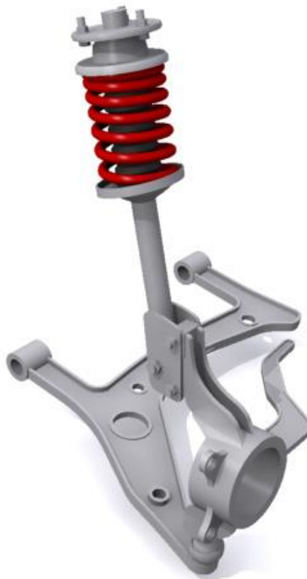
Σχήμα 2.6: Τρισδιάστατη ψηφιακή αναπαράσταση ανάρτησης με γόνατο MacPherson ( www.carbibles.com )
