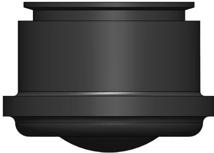
Σχήμα 5.26: Σφαιρικός σύνδεσμος (εξωτερικό τμήμα)
