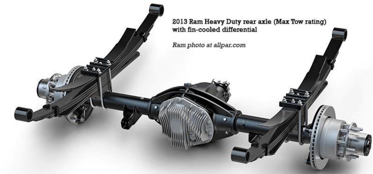
Σχήμα 2.1: Πίσω άξονας Hotchkiss από ημιφορτηγό τύπου Dodge Ram ( http://www.allpar.com )
