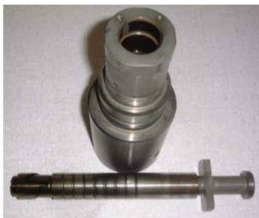
Εικόνα 16. Έμβολο και χιτώνιο αντλίας υψηλής πίεσης. Λήψη κατά την διάρκεια επισκευής συστήματος έγχυσης μηχανής πλοίου.
