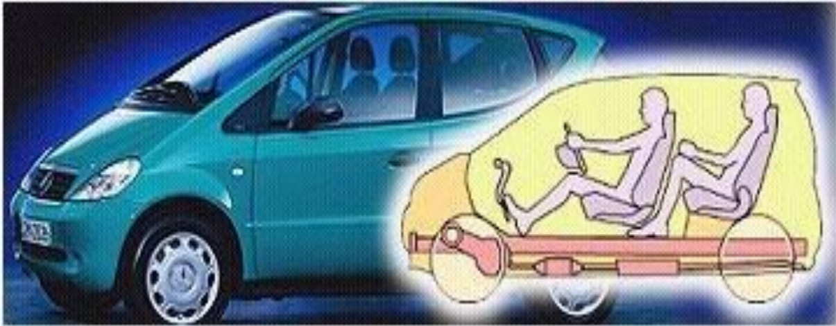
Εικόνα 1.9: Mercedes A-Class. Στο συγκεκριμένο μοντέλο γίνεται χρήση του πατώματος τύπου σάντουιτς.
