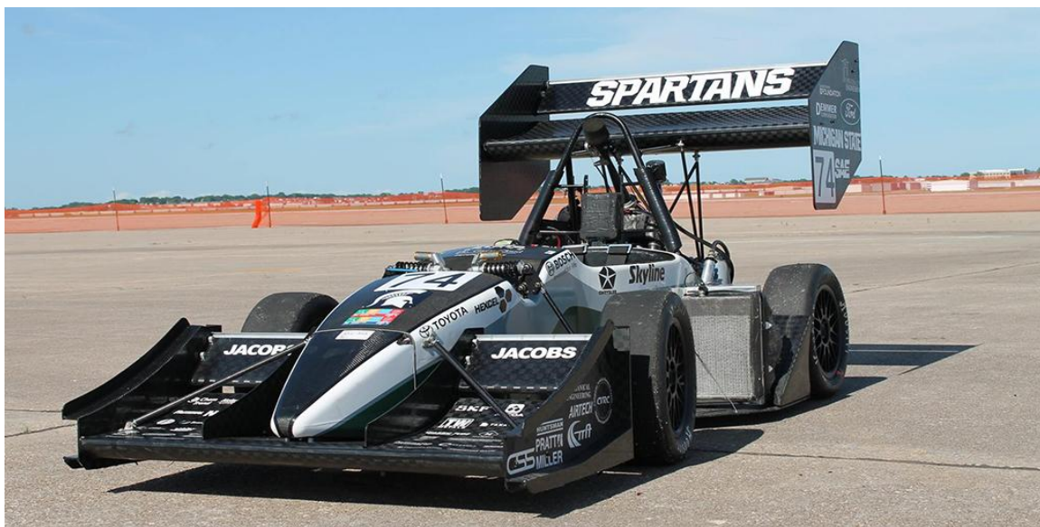
Εικόνα 5.5: Φόρμουλα με αεροδυναμικά βοηθήματα.
