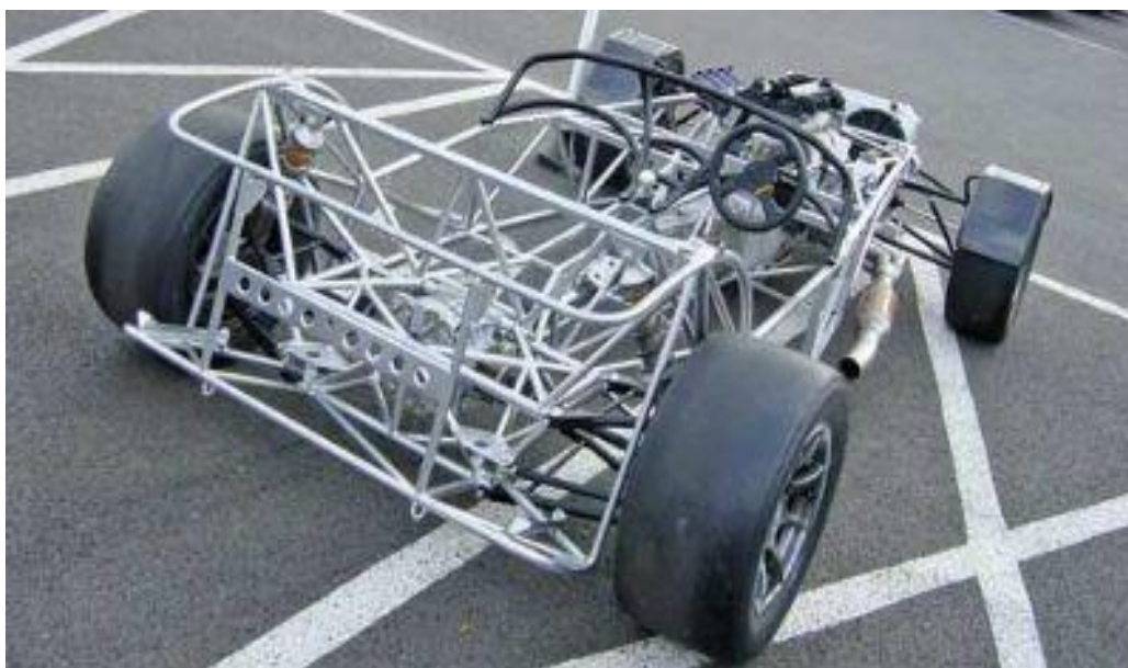
Εικόνα 15.1: Caterham CSR. Το πλαίσιο είναι κατασκευασμένο από χρωμιομολυβδαίνιο σχηματίζοντας περίπλοκη γεωμετρία.
