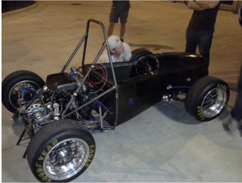
Εικόνα 5.6: Μονοθέσιο τύπου FSAE με πλαίσιο μονοκοque από σύνθετα υλικά.
