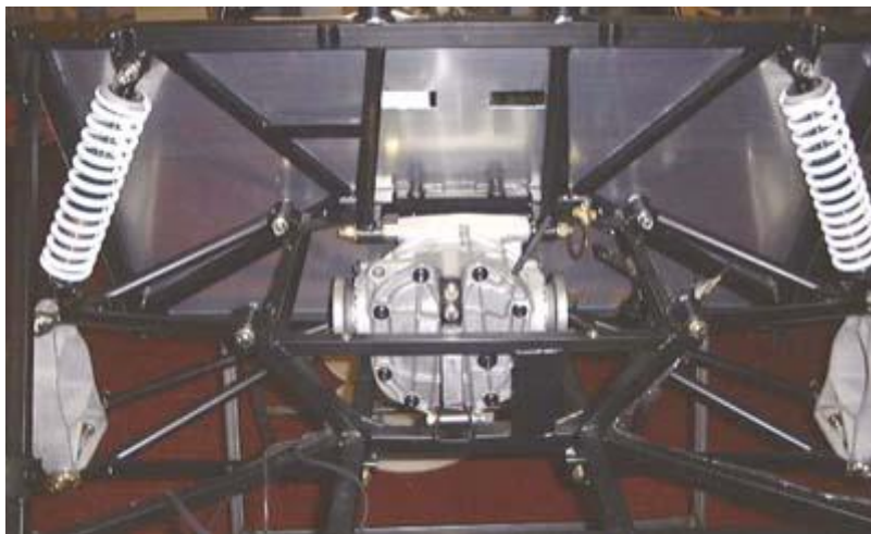
Εικόνα 2.9: Η ανεξάρτητη πίσω ανάρτηση των Westfield Sportscars.
