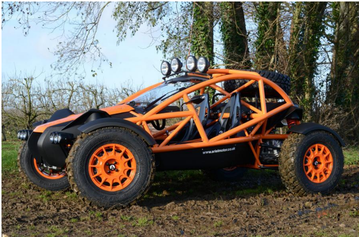
Εικόνα 10.3: Ariel Nomad, το πλαίσιο και ο κλωβός ασφαλείας αποτελούν μια ολότητα.
