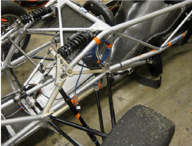
Εικόνα 5.2: Ανεξάρτητη ανάρτηση με διπλά ανισομεγέθη ψαλίδια και ράβδους συμπίεσης των αμορτισέρ.
