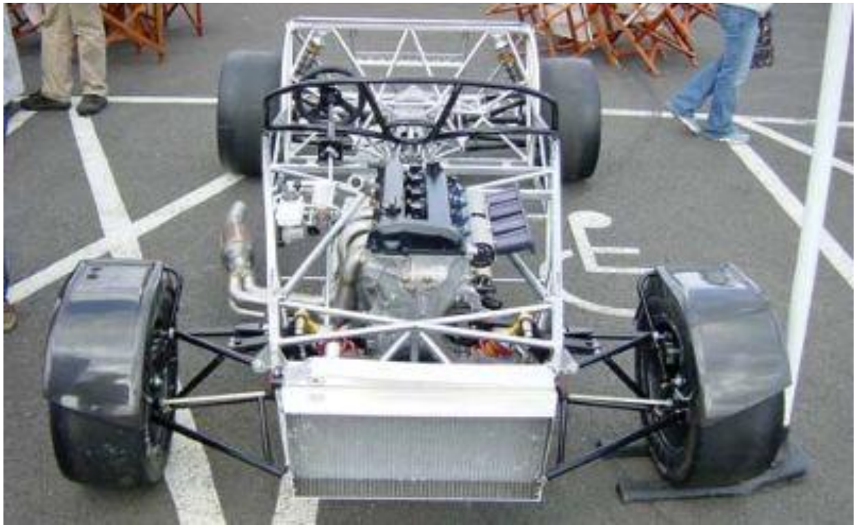
Εικόνα 14.11: Τοποθέτηση ψυγείων μπροστά από τη μετόπη.
