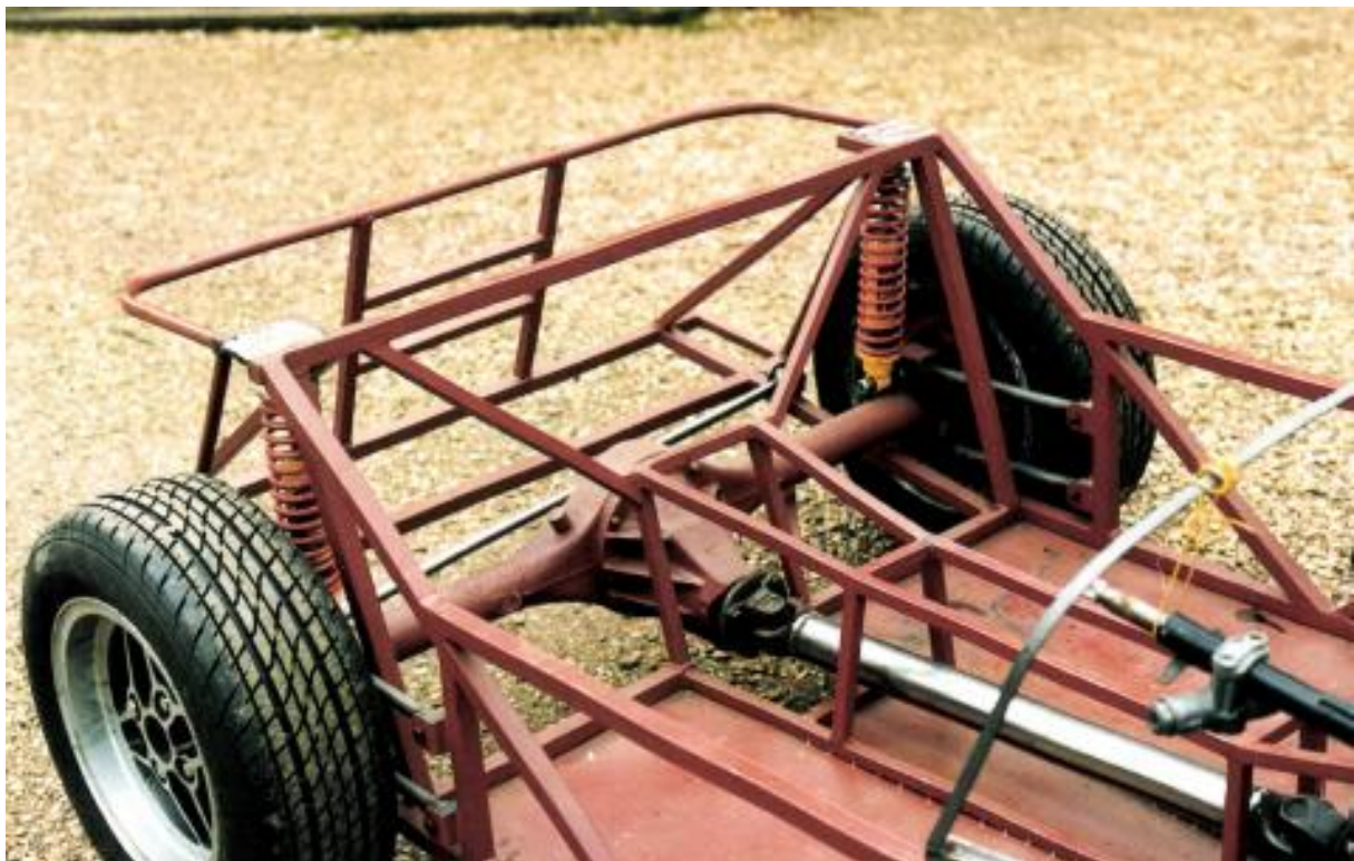
Εικόνα 4.6: Το πλαίσιο του πρώτου βιβλίου. Παρατηρείται χρήση άκαμπτου πίσω άξονα ενώ το πλαίσιο αποτελείται από λιγότερα μέρη μειώνοντας την στρεπτική ακαμψία.
