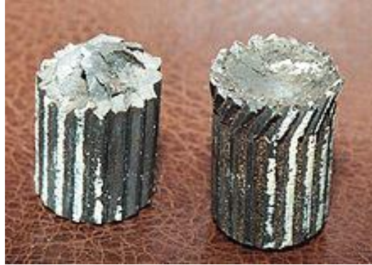
Εικόνα 2.1: Κατεστραμμένα ημιαξόνια από την εταιρεία Standard.
