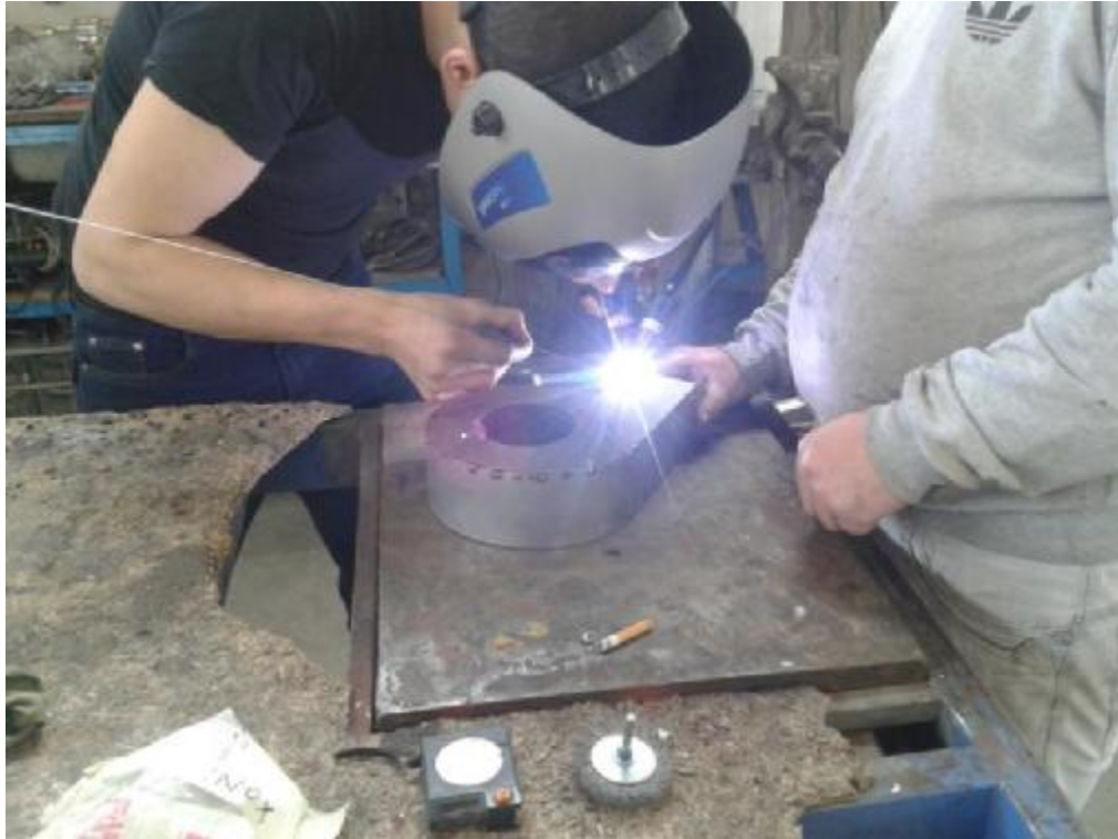
Εικόνα 4: Συγκόλληση εκτοξευτήρα αέρος (σαλίγκαρου)
