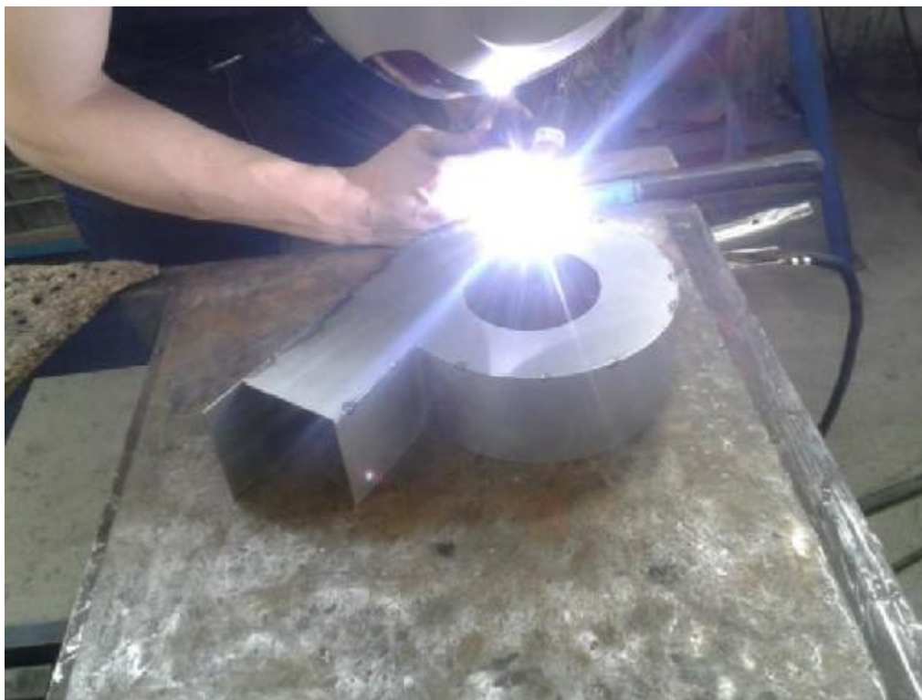
Εικόνα 5: Συγκόλληση εκτοξευτήρα αέρος (σαλίγκαρου)
