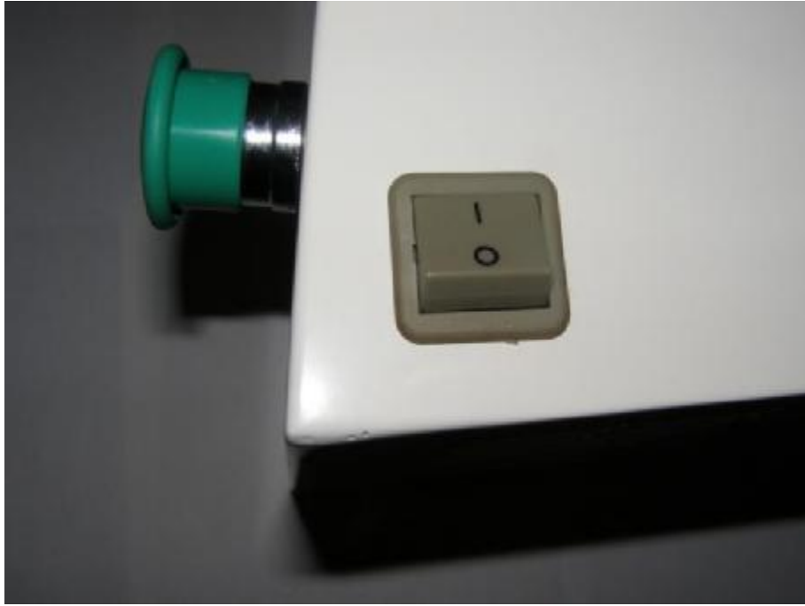
Εικόνα 25: Ηλεκτρικός διακόπτης τροφοδοσίας-διακοπής ηλεκτρικής ενέργειας στην αντίσταση.
