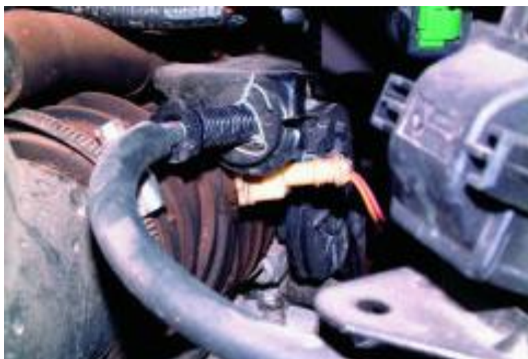
Σχήμα 2.10 Αισθητήρας θερμοκρασίας εισερχομένου αέρα στην πολλαπλή εισαγωγή. Συνήθως βρίσκεται αμέσως μετά από το φίλτρο αέρα στον αεραγωγό, που οδηγεί από το φίλτρο αέρα στην πολλαπλή εισαγωγή [3].
