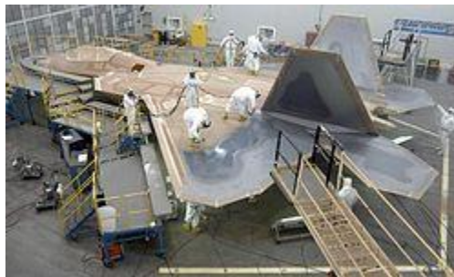
Εικόνα 3.0 Το F22 σε φάση βαφής [10]
