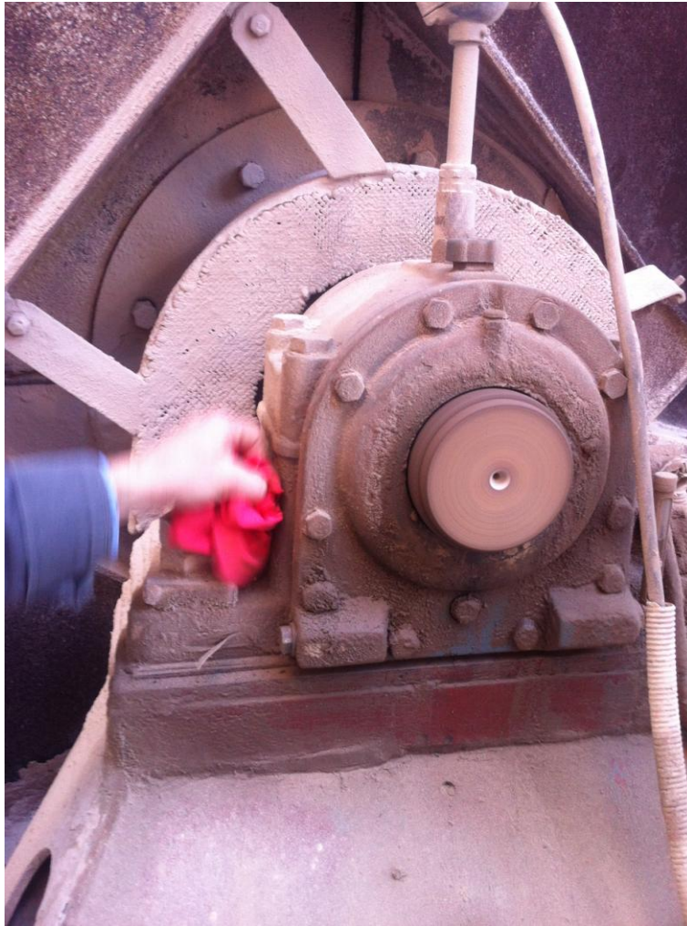
Εικόνα 2.2: Καθαρισμός σημείου επαφής κουζινέτου-αισθητηρίου
