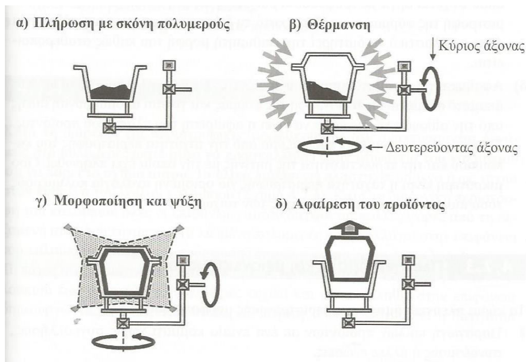
Σχήμα 5.2 Βασικά στάδια της διαδικασίας της περιστροφικής μορφοποίησης [21].
