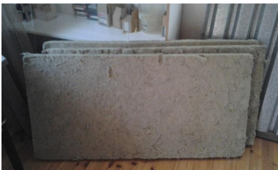
Εικόνα 5.7 : Μόνωση συλλέκτη στέγης οικίσκου
