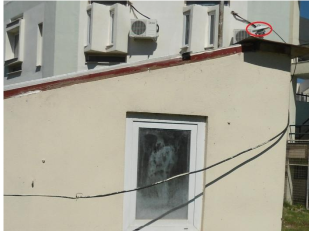
Εικόνα 7.12 : Πυρανόμετρο οικίσκου δοκιμών στο επίπεδο της στέγης του Εργαστηρίου ΑΠΕ ΤΕΙ Δυτικής Ελλάδας
