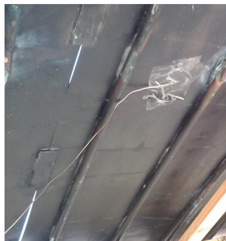
Εικόνα 5.2 : Τοποθέτηση θερμοζεύγους στην συλλεκτική επιφάνεια
