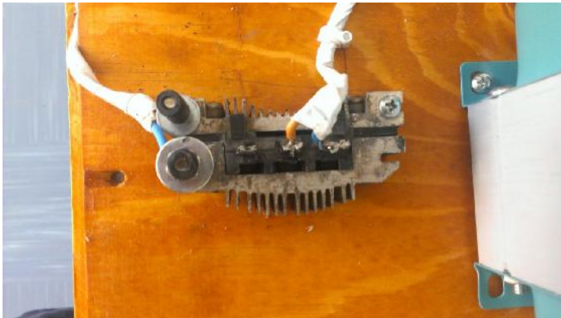
Εικόνα 4.34 Γέφυρα ανόρθωσης κατασκευής
