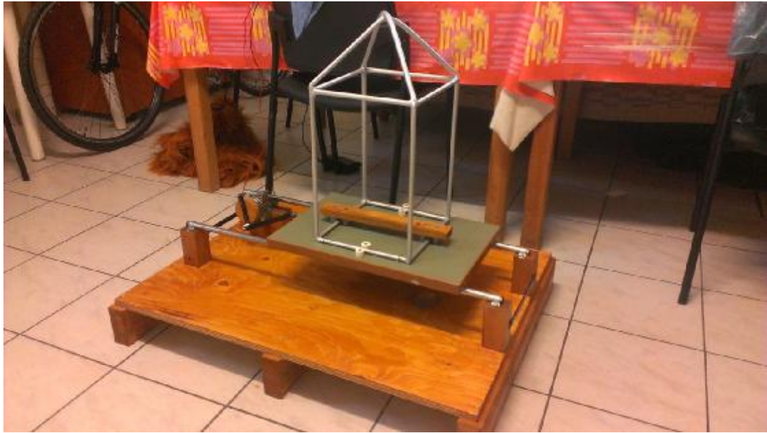
Εικόνα 4.19 Κτίριο τοποθετημένο στην σεισμική τράπεζα
