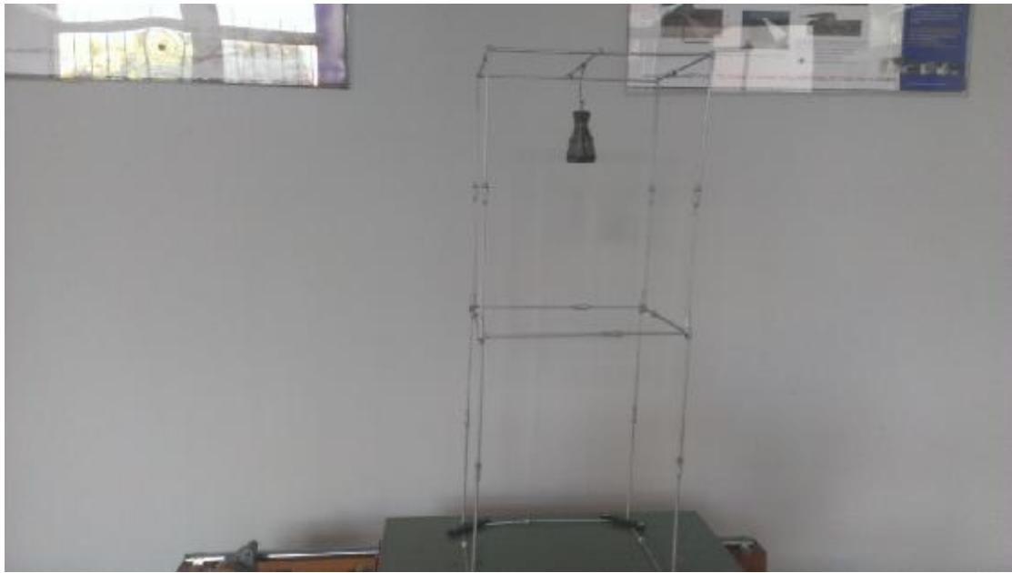
Εικόνα 4.42 Τοποθετημένος αποσβεστήρας στο κτίριο της κατασκευής
