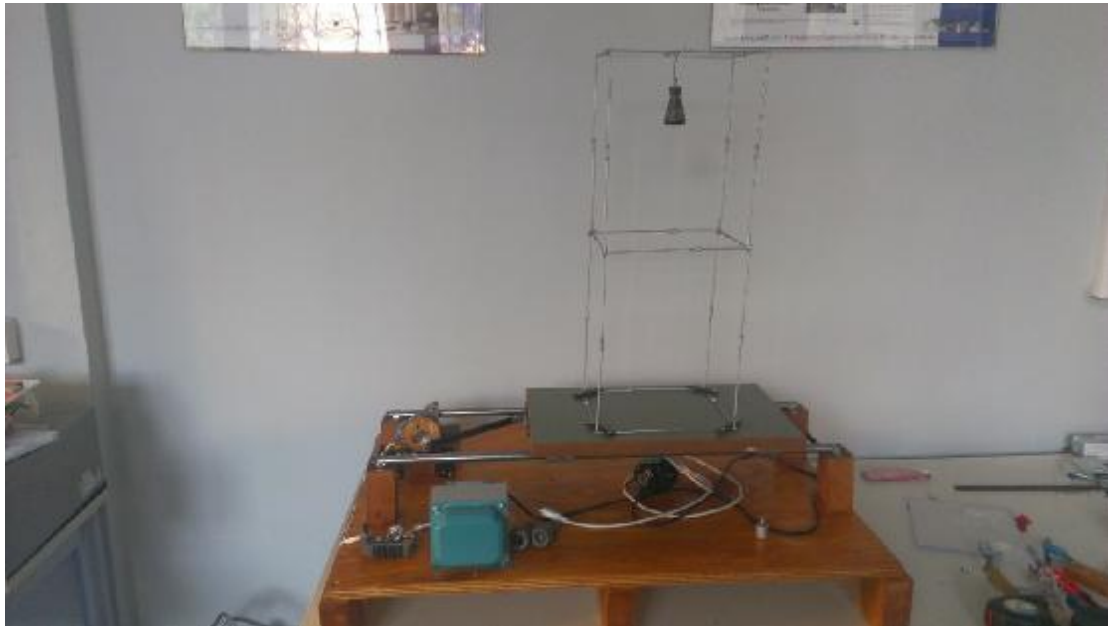
Εικόνα 4.1 Δυναμικός Αποσβεστήρας Μάζας Εκκρεμούς
