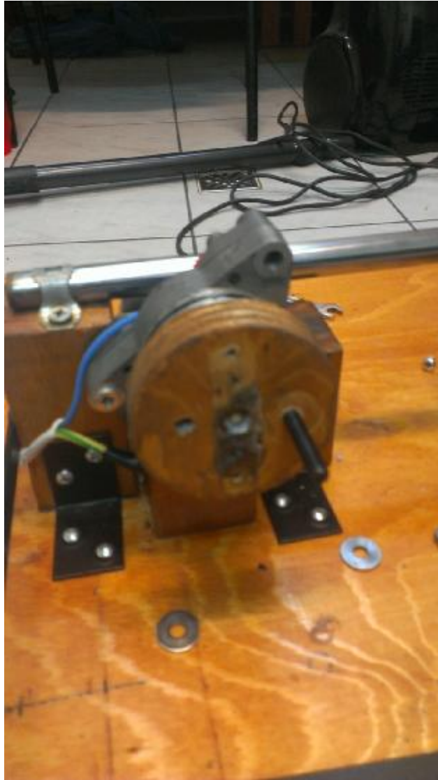
Εικόνα 4.38 Στρόφαλος από κόντρα πλακέ με βίδα στήριξης του διωστήρα
