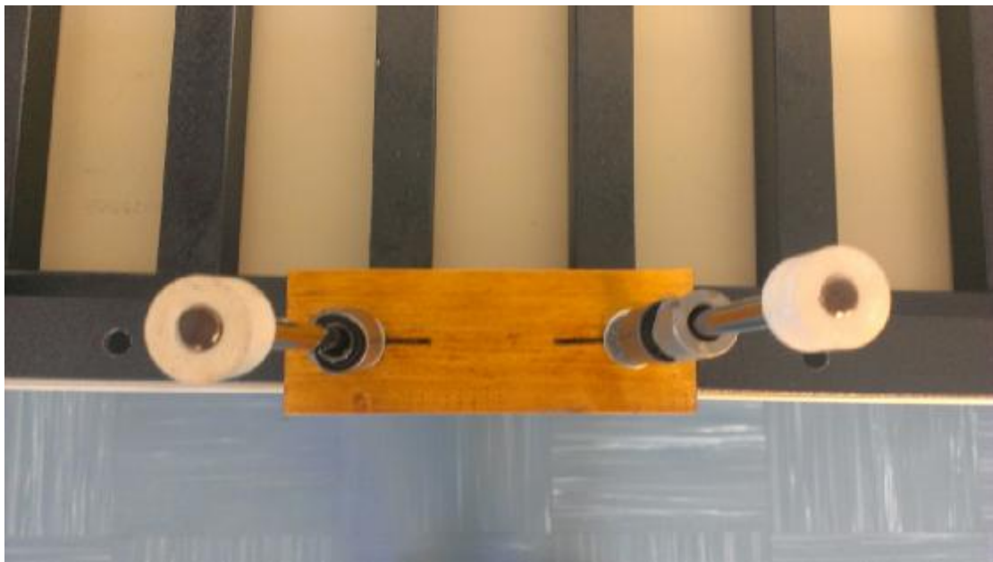
Εικόνα 4.46 Κάτοψη δυναμικού αποσβεστήρα Ελατηρίου - Μάζας
