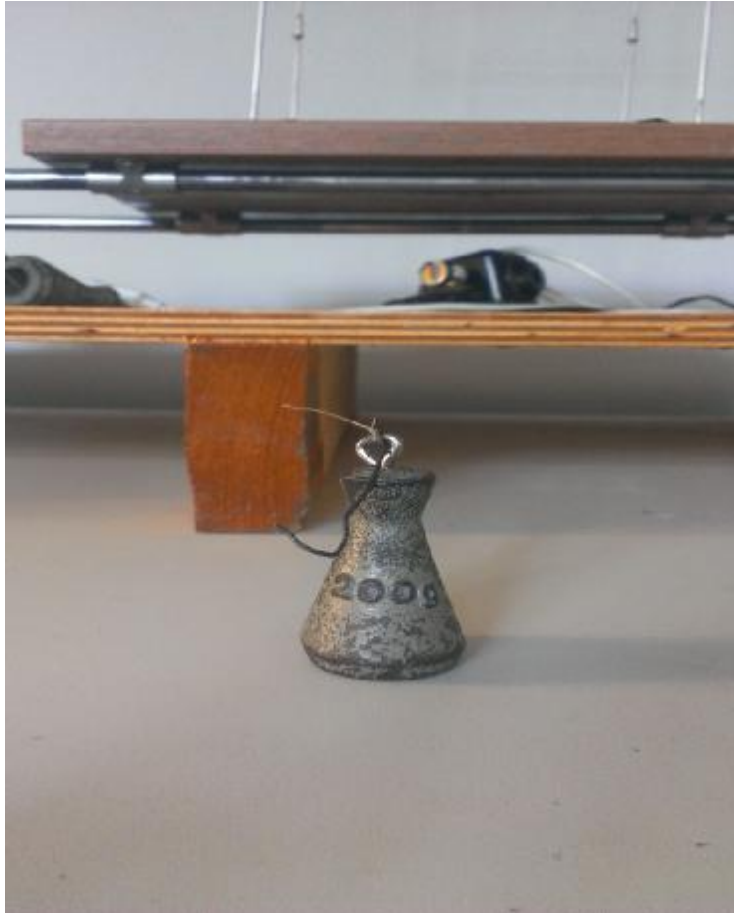
Εικόνα 4.41 Δυναμικός αποσβεστήρα μάζας – εκκρεμούς
