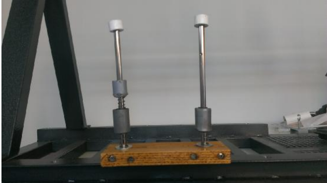
Εικόνα 4.45 δυναμικός αποσβεστήρας Ελατηρίου - Μάζας
