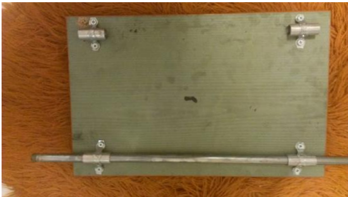
Εικόνα 4.10 Σεισμική πλάκα με οδηγούς και την μία ράγα
