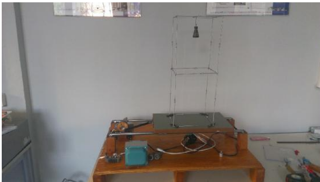
Εικόνα 4.24 Πακτωμένο κτίριο στην σεισμική πλάκα
