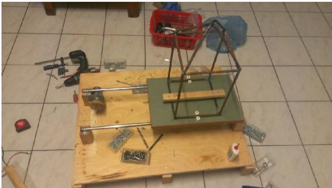
Εικόνα 4.18 Τοποθέτηση κτιρίου στην σεισμική τράπεζα
