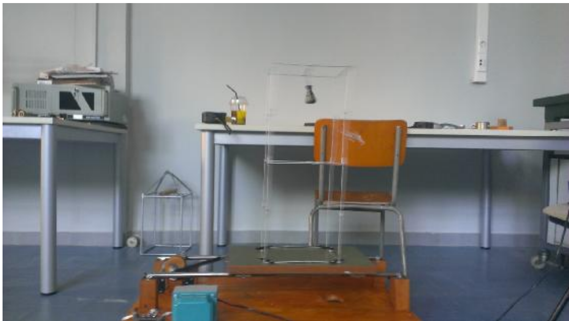
Εικόνα 4.43 Τοποθετημένος αποσβεστήρας στο κτίριο της κατασκευής κατά την διάρκεια δοκιμών
