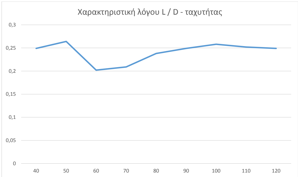
Σχήμα 5.43: Διάγραμμα λόγου L / D – ταχύτητας για το μοντέλο φορτηγού
