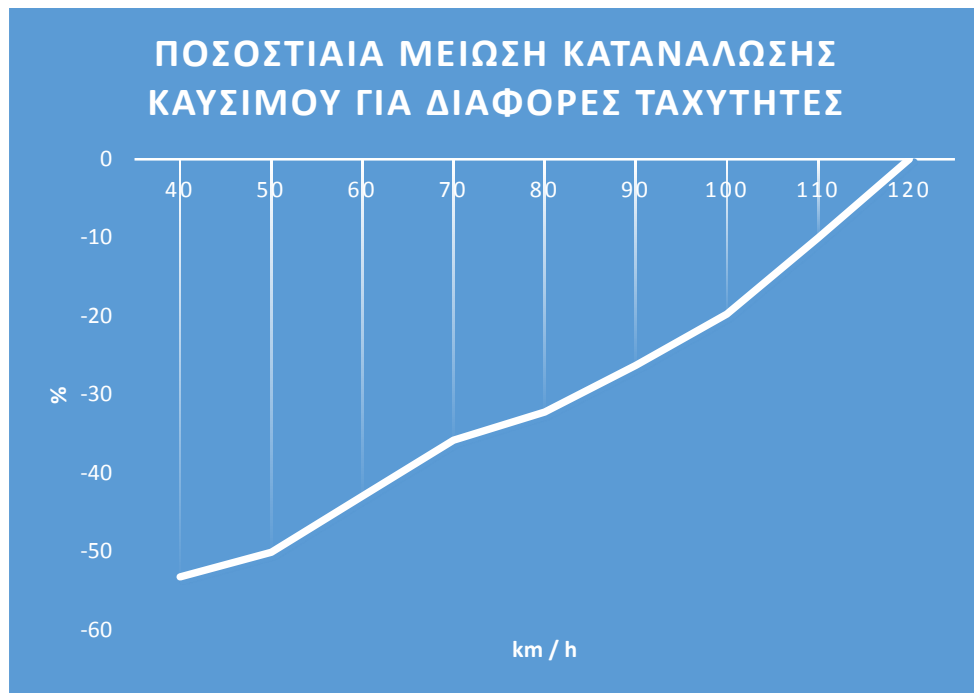
Σχήμα 5.44: Ποσοστιαία μείωση κατανάλωσης καυσίμου για διάφορες ταχύτητες για το μοντέλο φορτηγού
