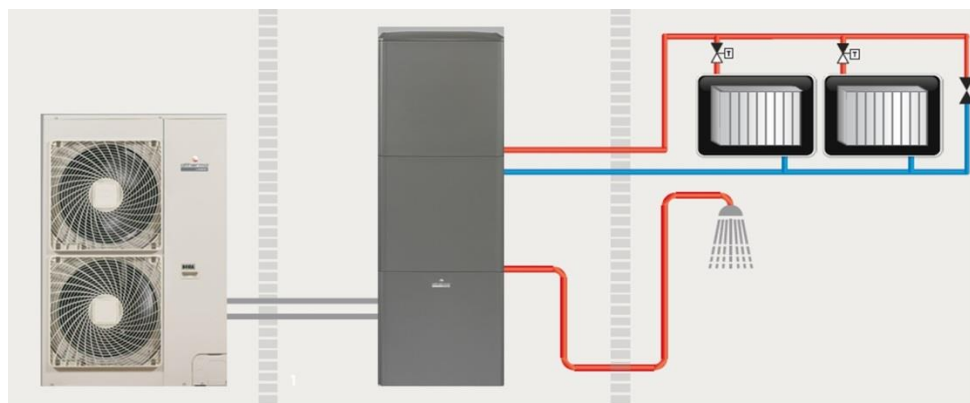
Εικόνα 1.20: Σύνδεση αντλίας θερμότητας με σώματα καλοριφέρ και ζεστό νερό χρήσης
