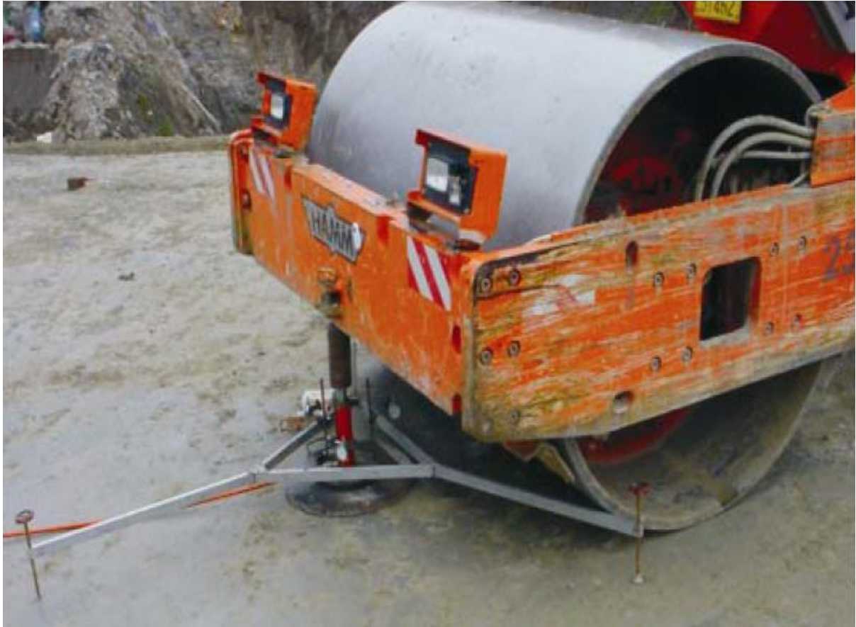
Εικόνα 3.1 Δοκιμή φορτιζόμενης πλάκας
