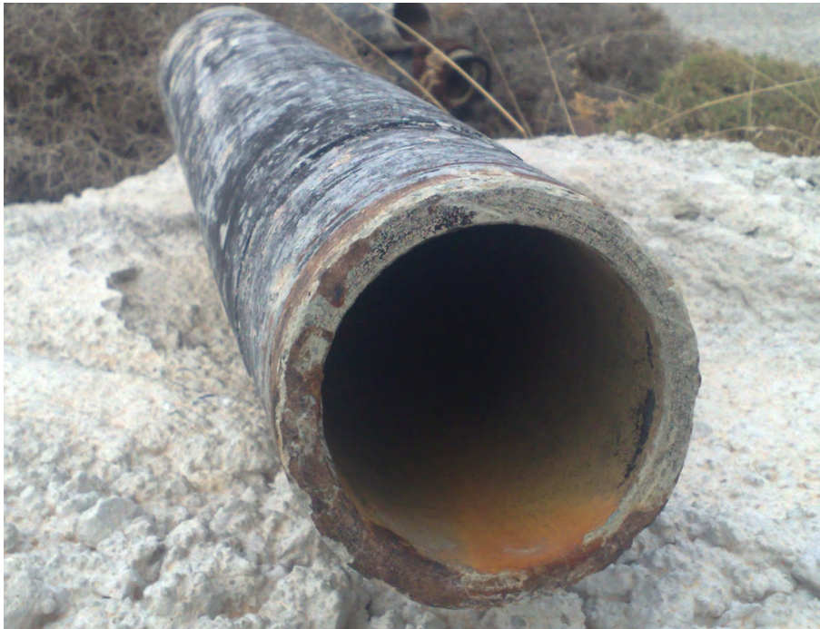
Εικόνα 10: τυπική διατομή σωλήνα από αμιαντοσίμεντο [Διαδίκτυο 7]
