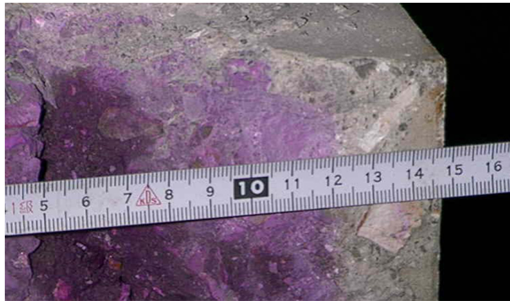
Εικόνα 2.2 Δοκίμιο σκυροδέματος το οποίο έχει ψεκασθεί με διάλυμα φαινολοφθαλείνης. Το τμήμα στο οποίο δεν παρουσιάζεται αλλαγή χρώματος (δεξιά) είναι ενανθρακωμένο. Το αριστερό τμήμα (χρώματος ροζ-βυσσινί) δεν έχει ενανθρακωθεί. [1]
