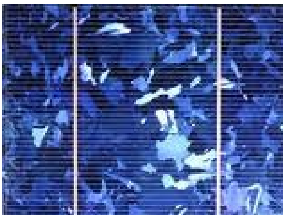
Σχήμα 1.19 Φωτοβολταϊκό στοιχείο πολυκρυσταλλικού πυριτίου [6].
