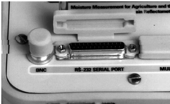
Εικόνα 3.10 Πλαστικό κάλυμμα θύρας BNC
