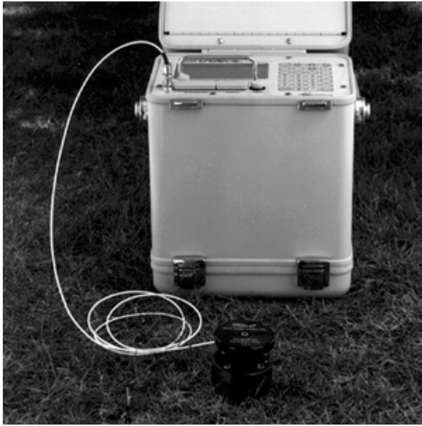
Εικόνα 3.31 Πιέστε τους κυματοδηγούς μέσα στο έδαφος μέχρι το σημείο που να μην φαίνονται τα στελέχη τους.
