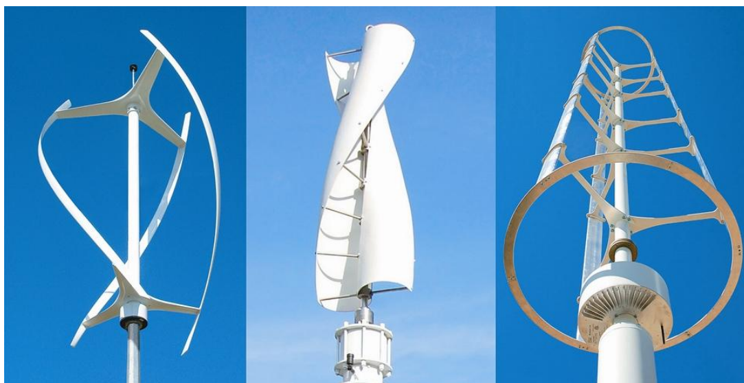
[Εικ.21] Ανεμογεννήτριες κατακόρυφου άξονα προσφέρονται για οικιακή ενεργειακή αυτονομία.
