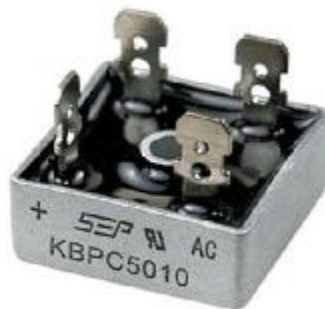
Σχήμα 2.10: Η ανορθωτική γέφυρα του κυκλώματος ισχύος.
