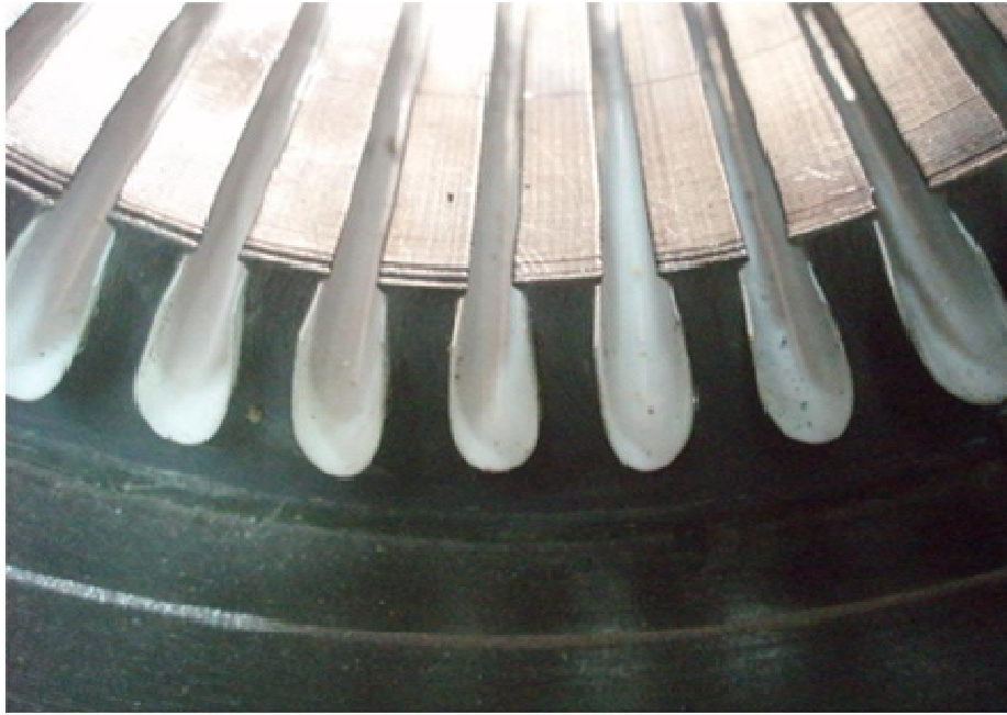
Σχήμα 3.2: Ελασματοποίηση στάτη σε ασύγχρονη μηχανή
