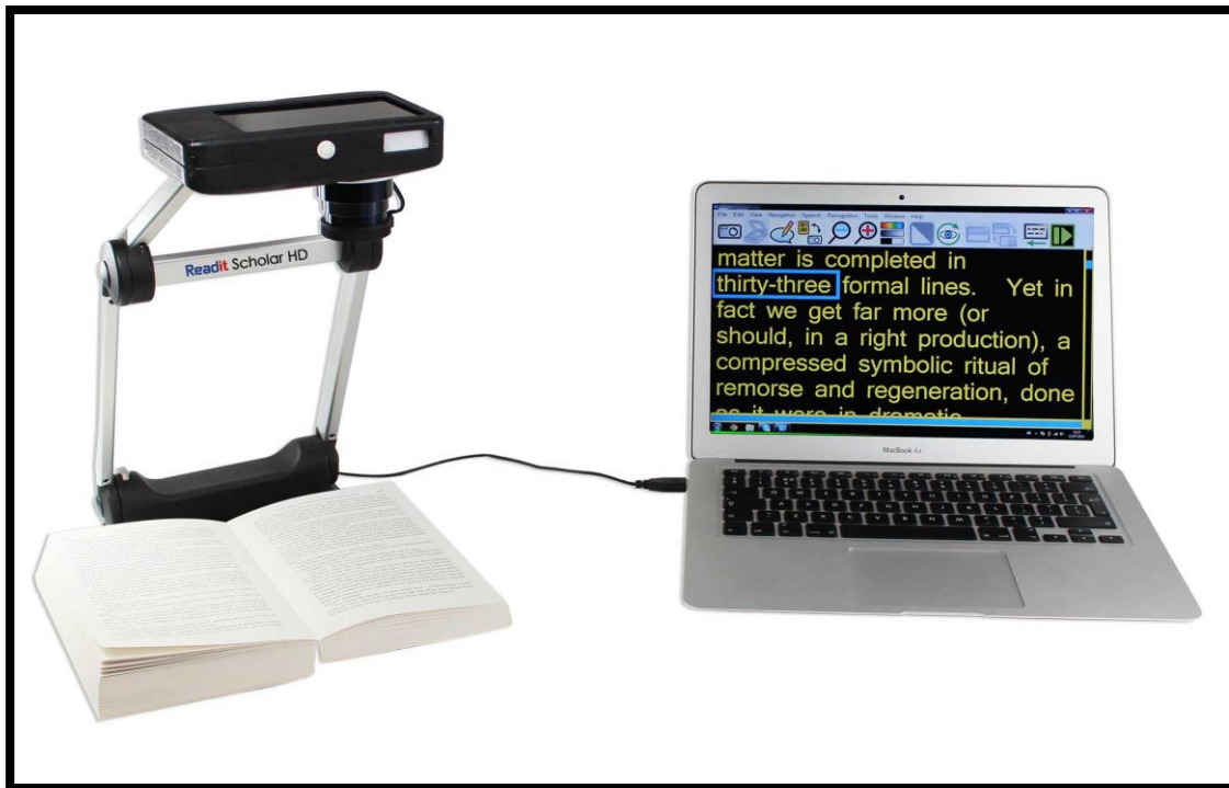
Εικόνα 21: Σύστημα μεγεθυντικού φακού υποστηριζόμενο από ηλεκτρονικό υπολογιστή
