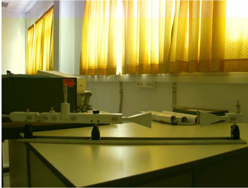
Εικόνα 5.1. Διάταξη για τη μέτρηση του μήκους κύματος \lambda μικροκυμάτων με τη μέθοδο στάσιμων κυμάτων χωρίς τη χρήση του ειδικού ανιχνευτή DP.
