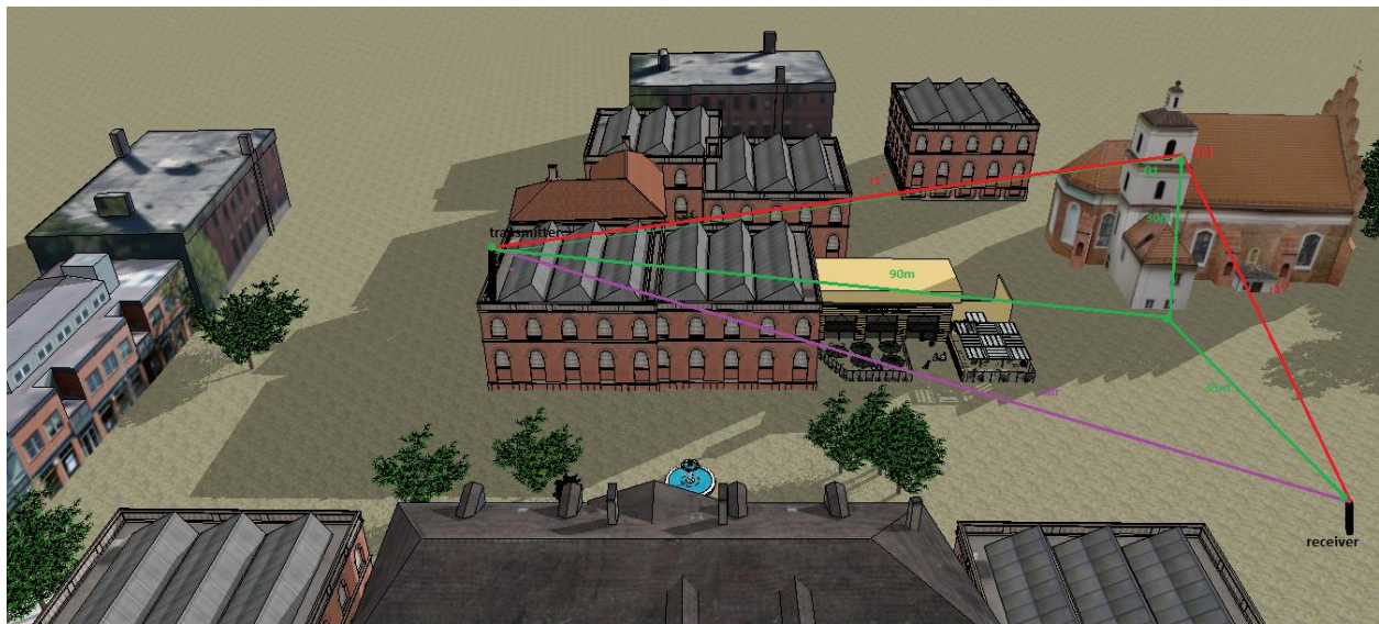
Σχήμα 5.2. Πρώτη ανακλώμενη ακτίνα
