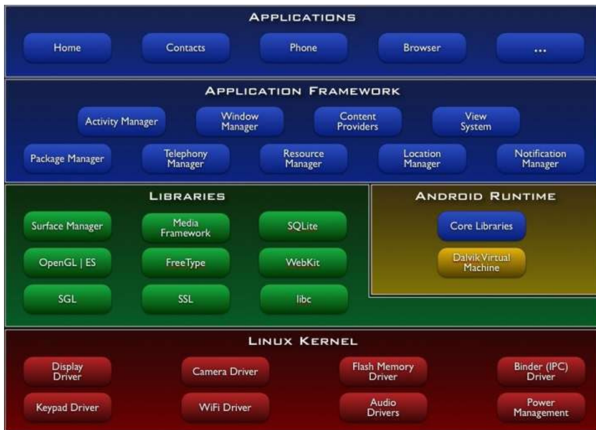
Εικόνα 2.2: Η στοιβά της αρχιτεκτονικής του λογισμικού Android αποτελείται από πέντε επίπεδα μπλε είναι γραμμένα σε γλώσσα προγραμματισμού Java και τα πράσινα σε γλώσσα προγραμματισμού C και C++ και τρέχουν στην εικονική μηχανή Davlik.
