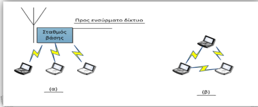
Εικόνα 1.32 (α) Ασύρματη δικτύωση με σταθμό βάσης (β) Δικτύωση ad hoc
