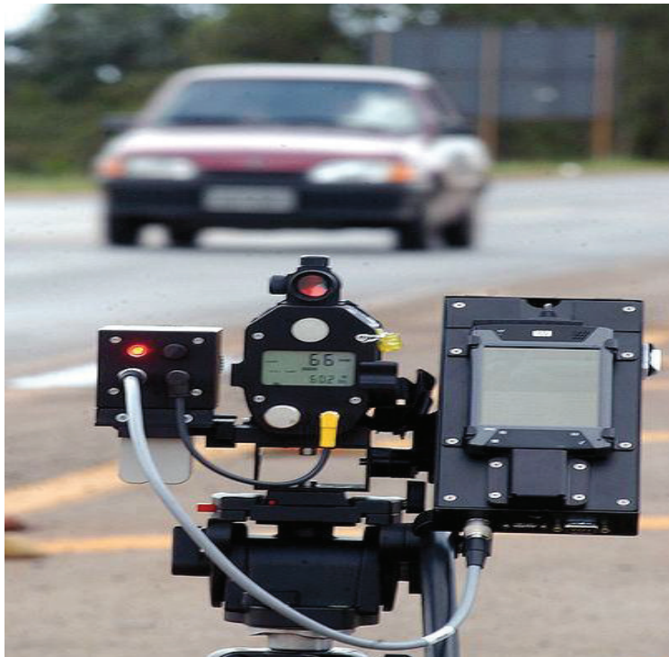
Εικόνα 18: Όπλο Radar που μετράει την ταχύτητα ενός αυτοκινήτου
