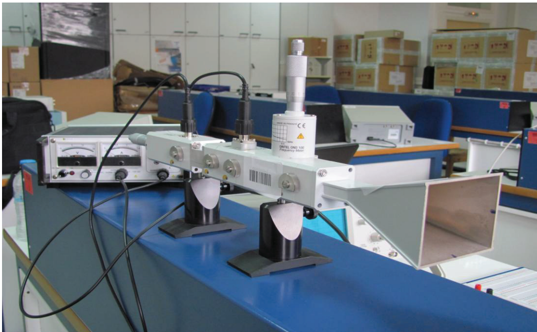
Εικόνα 25: Κεραία εκπομπής ηλεκτρομαγνητικών κυμάτων
