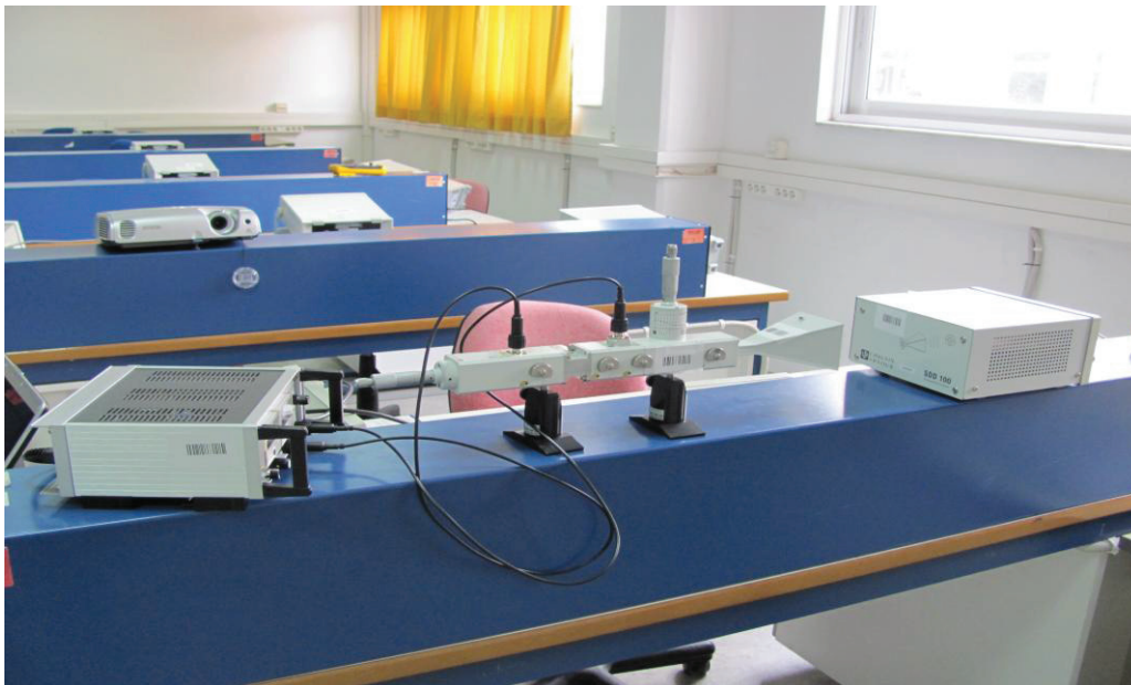
Εικόνα 23: Πειραματική διάταξη φαινομένου doppler
