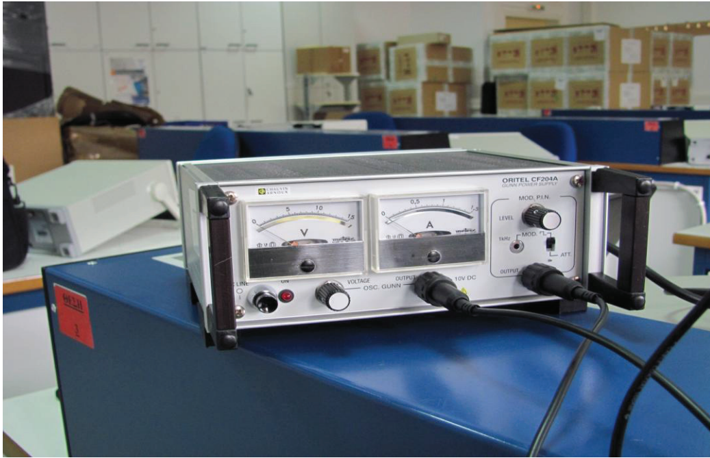
Εικόνα 24: Τροφοδοτικό της Gunn διόδου
