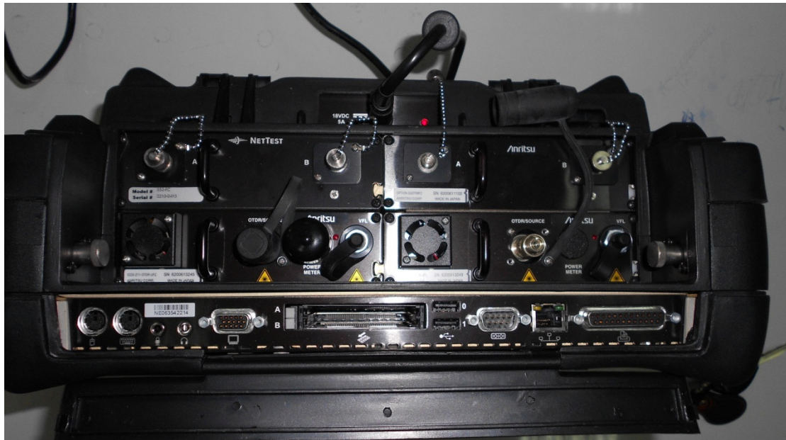
Εικόνα 3.39: Αποψη των διαθέσιμων θυρών σύνδεσης του OTDR.
