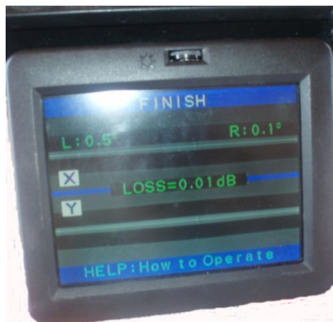
Εικόνα 3.29: Οθόνη εμφάνισης απωλειών σύνδεσης μετά την συγκόλληση
