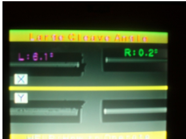
Εικόνα 3.32: Μήνυμα λάθους λόγω φθοράς στο μανδύα του rigtail(μεγάλη γωνία κοπής)
