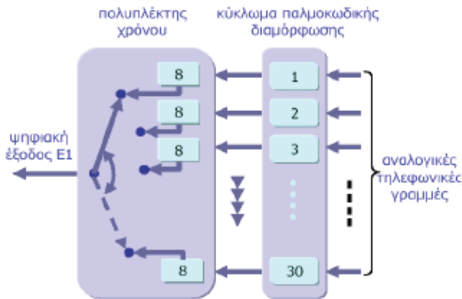
Σχήμα7: Σύστημα πολύπλεξης αναλογικών σε ψηφιακές γραμμές
