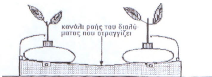
Εικ. 16 Σύστημα με ανακύκλωση θρεπτικού διαλύματος
