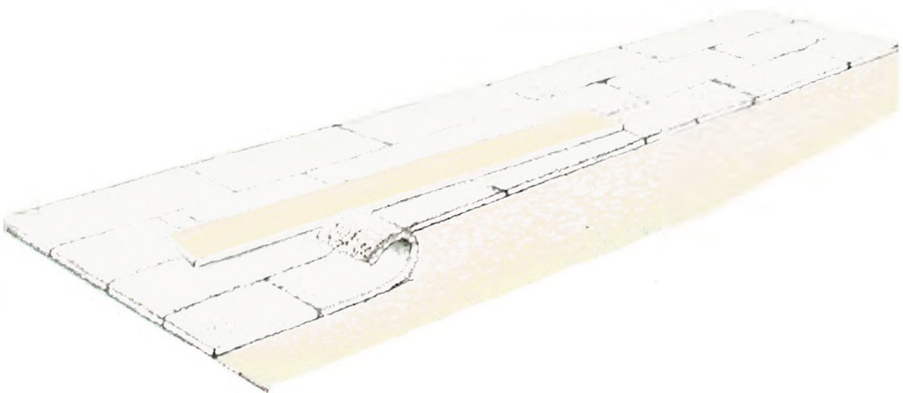
Τοποθέτηση Λωρίδων Έτοιμου Χλοοτάπητα
