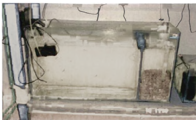
Σχήμα 2.5. Ενυδρείο εγκλιματισμού τσιπούρας, στο οποίο διακρίνεται το βιολογικό φίλτρο πυθμένα, ο κυκλοφορητής νερού και το φίλτρο skimmer.
