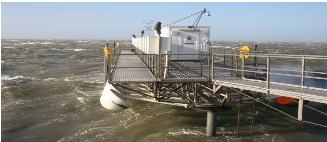
Εικόνα 4.17: Το μοντέλο Wave Star κλίμακας 1:10 στο Nissum Bredning της Δανίας. Διακρίνονται οι σημαδούρες σε ανυψωμένη θέση εκτός λειτουργίας.
