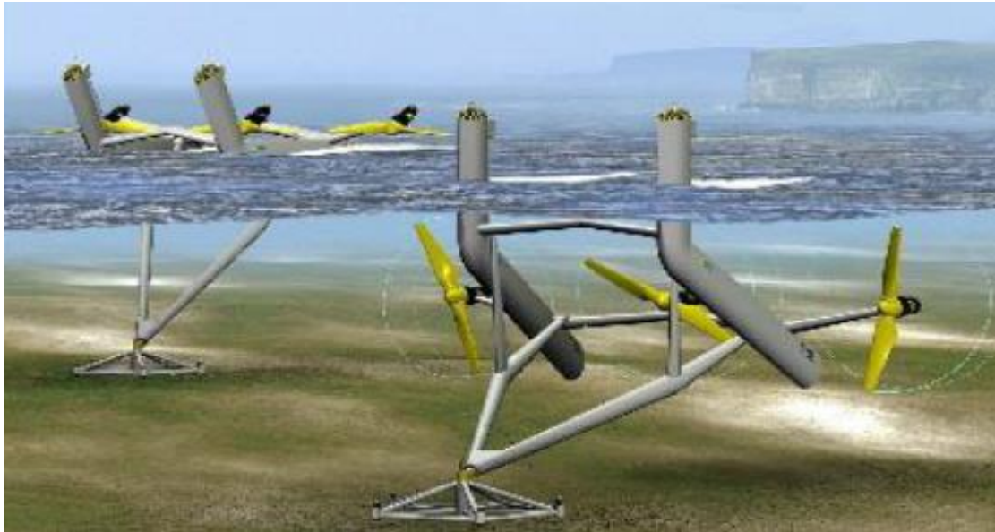
Εικόνα 3.5: Η συσκευή Triton 3 κατάλληλη για βάθος μεταξύ 35 – 55 μέτρα.
