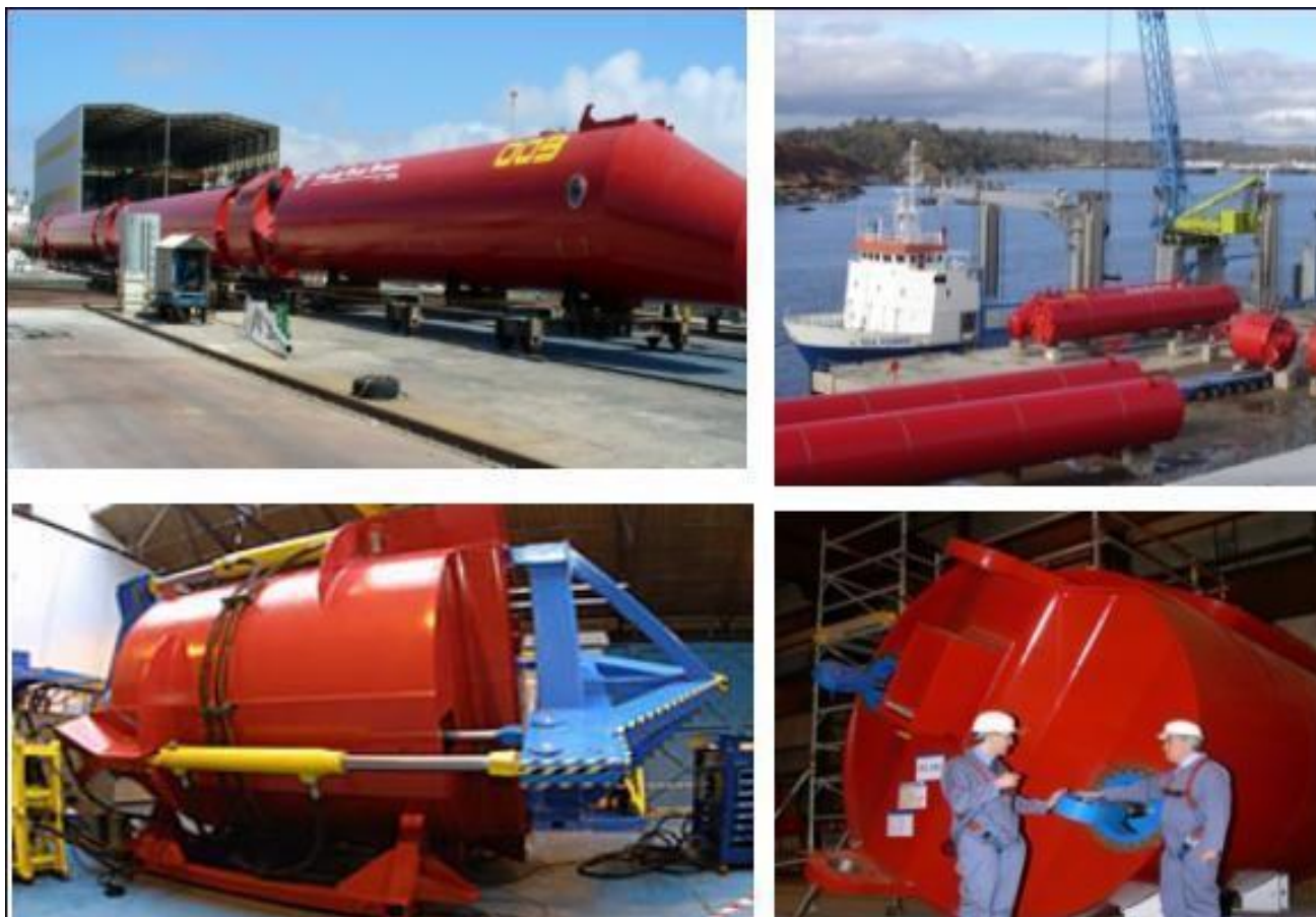
Εικόνα 4.29: Φωτογραφίες από τα διάφορα στάδια κατασκευής και μεταφοράς ενός μετατροπέα Relamis συνολικής ισχύος 750kW.
