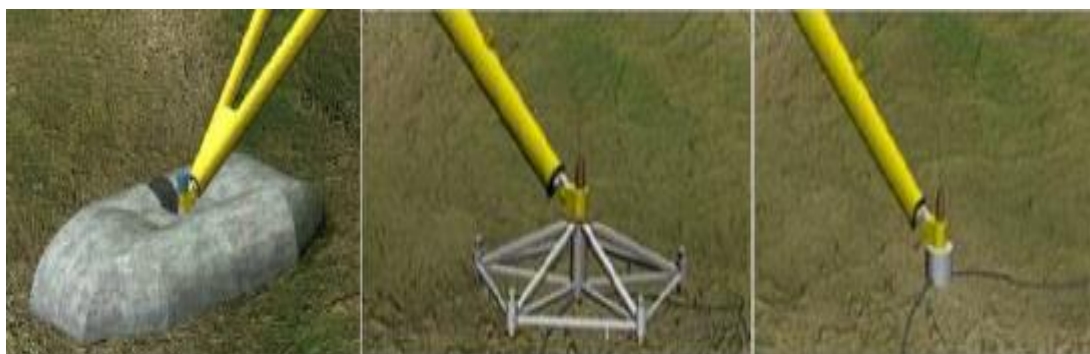
Εικόνα 3.6: Βάσεις στήριξης μόνο με τη βοήθεια της βαρύτητας, καρφωμένο πλαίσιο και με μονό πάσσαλο.
