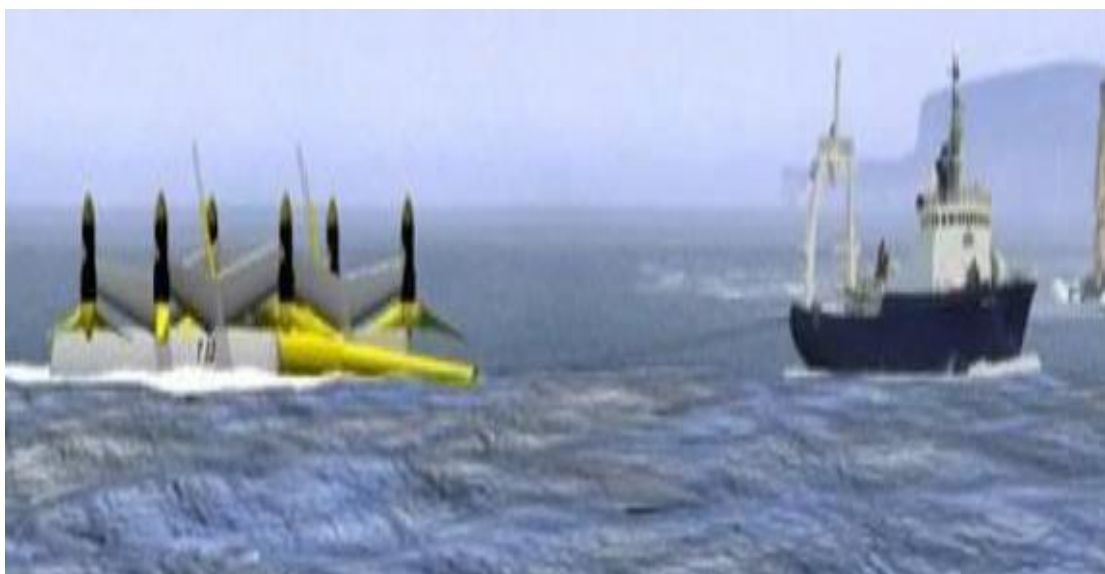
Εικόνα3.7: Μικρό ρυμουλκό μεταφέρει τη συσκευή Triton 6 στην καθορισμένη θέση.
