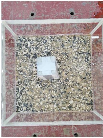
Εικόνα 4.39 Δείγμα Α Δοκιμή 75% βύθιση εκ της αριστερής πλευράς κάτωψη, εμφανή στα δεξιά του δοκιμίου συγκέντρωση νερού
