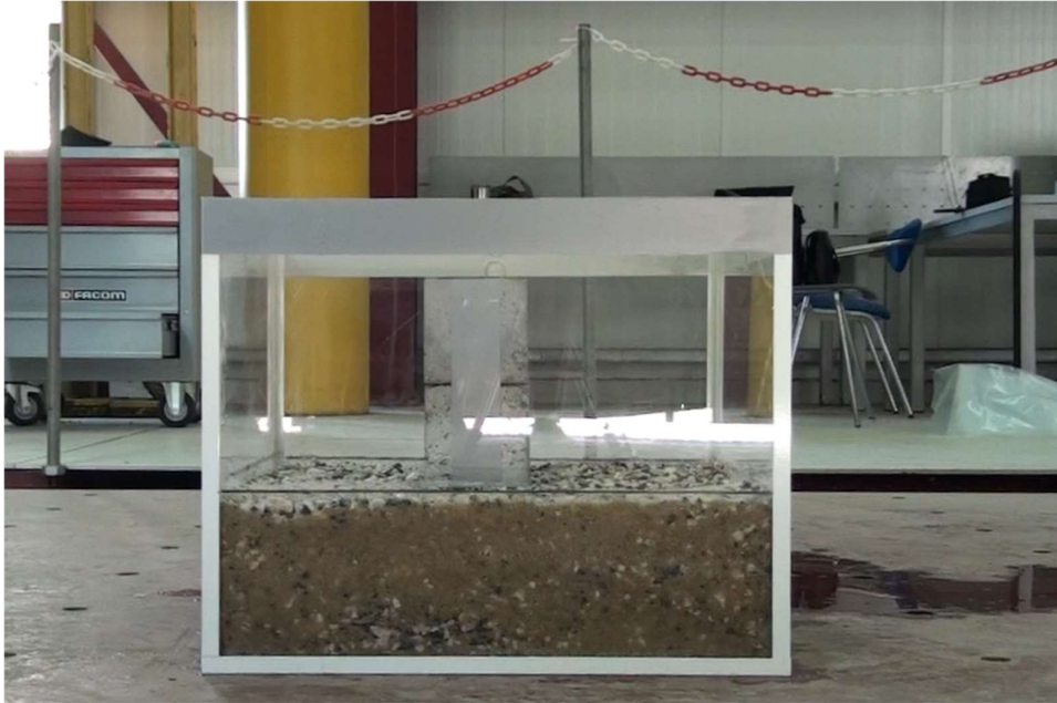
Εικόνα 4.34 Δείγμα Α Δοκιμή 75% πριν την φόρτιση
