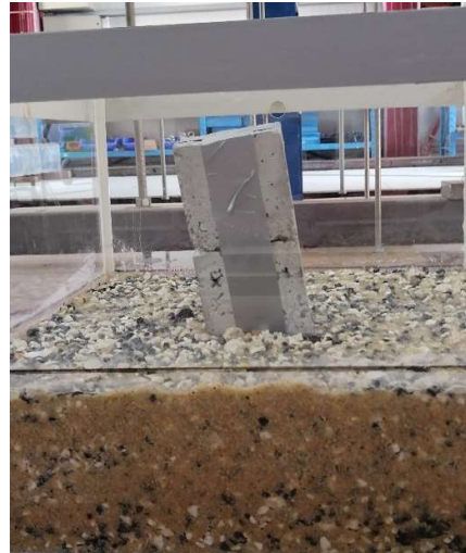
Εικόνα 4.37 Δείγμα Α Δοκιμή 75% βύθιση εκ της αριστερής πλευράς πλάγια όψη
