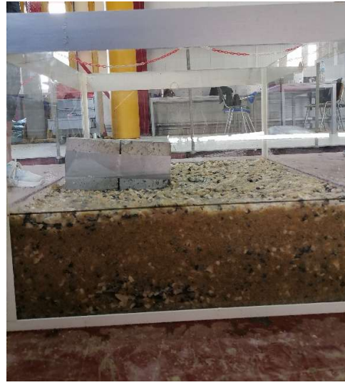
Εικόνα 4.45 Δείγμα Α Δοκιμή 100% ανατροπή του δοκιμίου πρόσοψη
