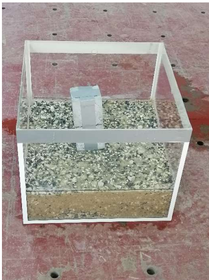
Εικόνα 4.38 Δείγμα Α Δοκιμή 75% βύθιση εκ της αριστερής πλευράς
