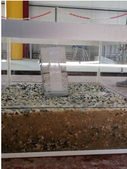
Εικόνα 4.36 Δείγμα Α Δοκιμή 75% βύθιση εκ της αριστερής πλευράς πλάγια όψη
