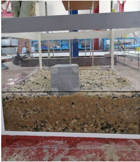
Εικόνα 4.44 Δείγμα Α Δοκιμή 100% ανατροπή του δοκιμίου πλάγια όψη
