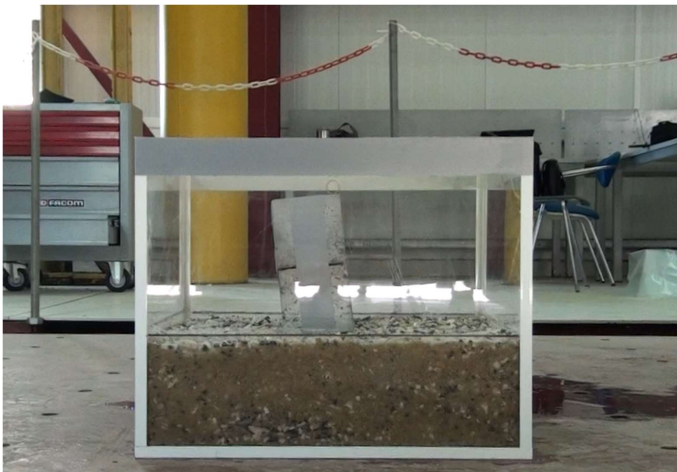
Εικόνα 4.35 Δείγμα Α Δοκιμή 75% μετά την φόρτιση
