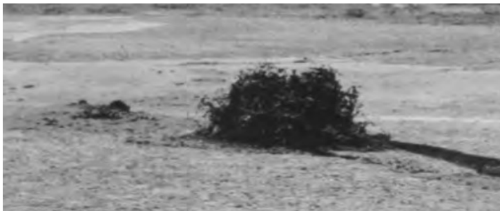
Εικόνα 1.23 Βρασμός άμμου που προκλήθηκε από ρευστοποίηση υποκείμενων ιζημάτων το 1978, Miyagi-ken-Oki, σεισμός Ιαπωνία, SOIL LIQUEFACTION DURING EARTHQUAKES, σελ. 2
