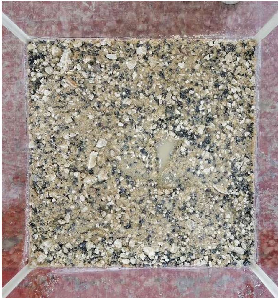
Εικόνα 4.46 Δείγμα Α Δοκιμή 100% κάτοψη της διάταξης, εμφανής μετακίνηση του υλικού, ανάδυση βαρύτερων αδρανών, ανάδυση νερού.
