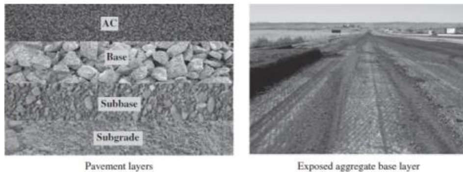
Εικόνα 6 Τυπικές στρώσεις σε οδόστρωμα
