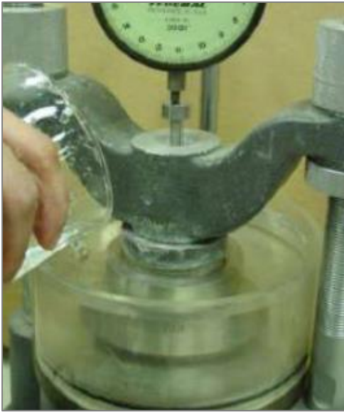
Εικόνα 4. Πλήρωση κοψέλης με νερό
