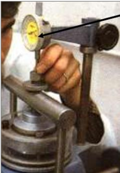
Εικόνα 3. Τοποθέτηση στη συσκευή φόρτισης
