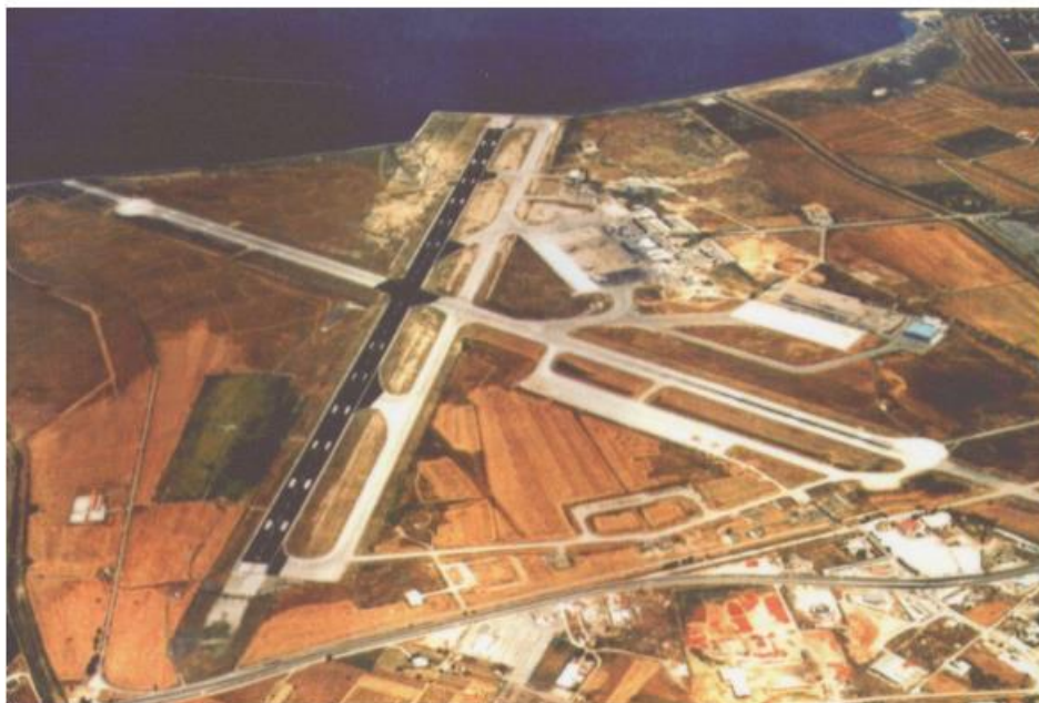
Εικόνα 2.12: Τεμνόμενοι διάδρομοι αεροδρομίου «Μακεδονία».
