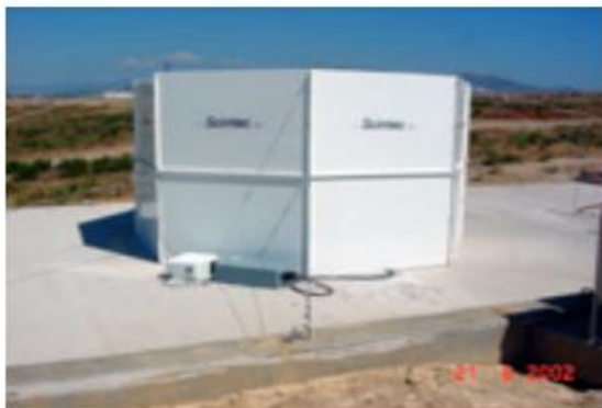
Εικόνα 2.6: Εγκατάσταση ακουστικού ραντάρ (SODAR) για ανίχνευση δεδομένων ανέμου.
