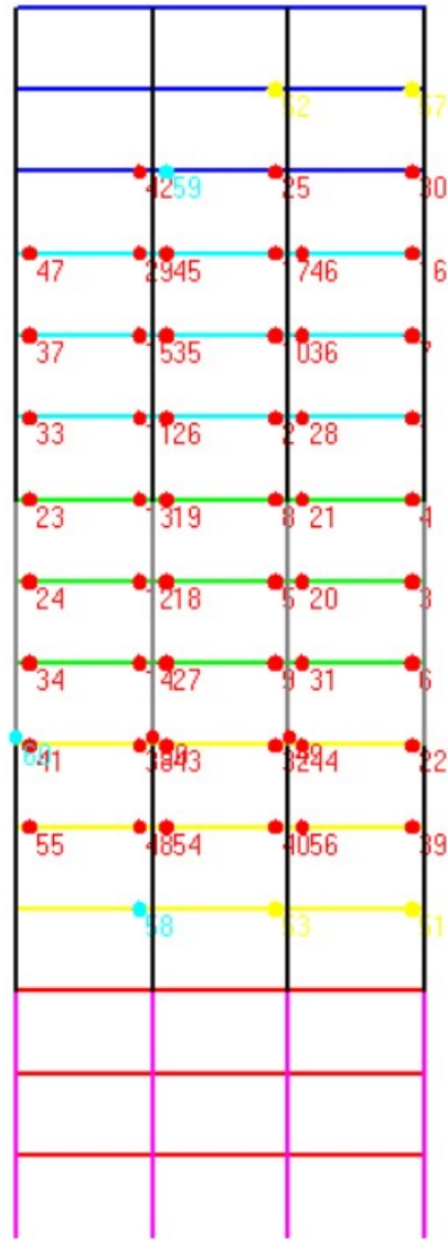
Εικόνα 3.50 : Θέσεις πλαστικών αρθρώσεων για μέγιστο ασκούμενο φορτίο
