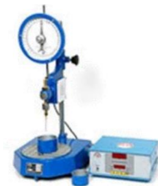
Εικόνα 5.1: Συσκευή δοκιμής διείδυσης
