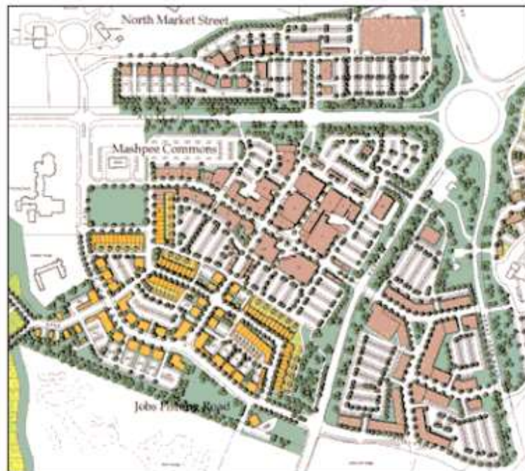
Εικόνα 3. Το σχέδιο του 1986 για το Mashpee Commons όπου πέντε οικιστικές γειτονίες σε μορφή TND σχεδιάστηκαν γύρω του ( https://cfcog.org )
