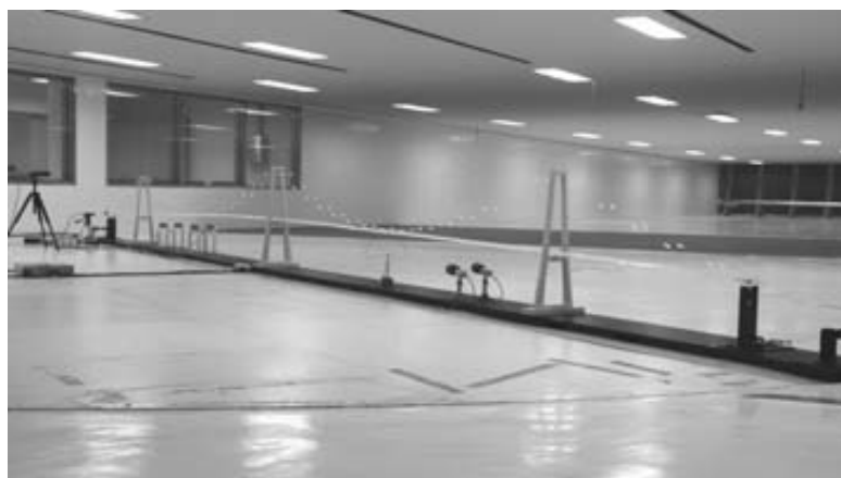
Εικόνα 5.2.15 Μακέτα γέφυρας Cheon-Sa σε κλίμακα 1/180, Από «Practical Design of Continuous Two Main-span Suspension Bridge in Korea», των Jung et al., Σεπτέμβριος 2010, Στο Large Structures and Infrastructures for Environmentally Constrained and Urbanised Areas , σελ.285., Copyright 2010 του Jung et al.
